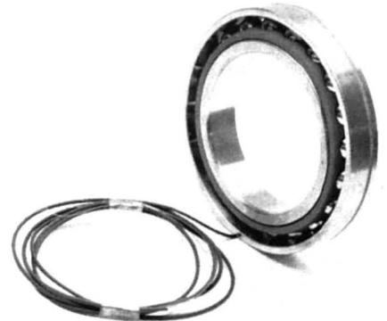
Bild 4. Schräg angestelltes Rillenkugellager als Kraftmeßlager präpariert
