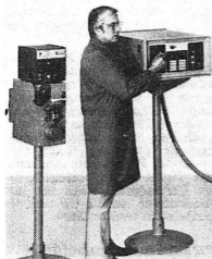
Die numerisch gesteuerte Konturen-Bandsägemaschine „2605 NC“ ist mit ihrem „Line-Grind-Band“ für Werkstoffe bis 65 HRC ausgelegt.
