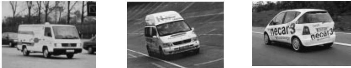
*Abb. 1.2: Die mit PEM-Brennstoffzellen als Antriebssysteme von Daimler-Benz vorgestellten Prototypen (NECAR). (Von links nach rechts: NECAR I, NECAR II, und NECAR III)*
