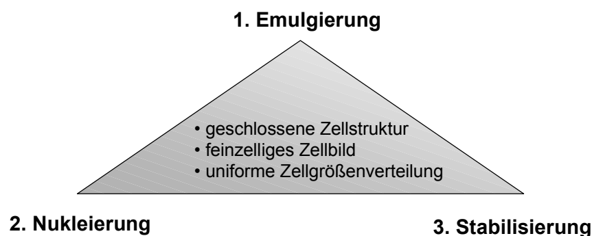
Abb. 1.4: Goldschmidt-Dreieck zur Darstellung der verschiedenen Aufgaben eines Schaumstabilisators bei der PUR-Schaumherstellung: Emulgierung, Nukleierung, Stabilisierung
