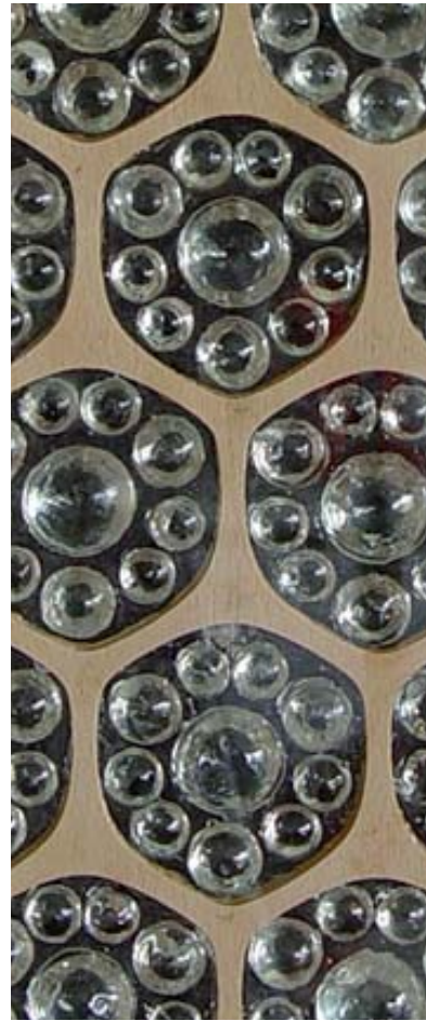
Abb. 3.4.12: Modellausschnitt einer autosensitiven Verschattungsstruktur im Detail
