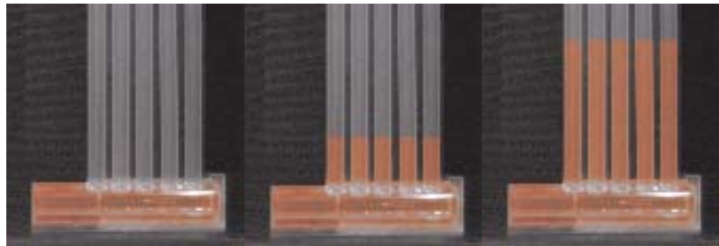
Abb. 4.3.10: Versuchsmodell eines farbgefüllten Tanks mit angeschlossenen Kapillarröhrchen
