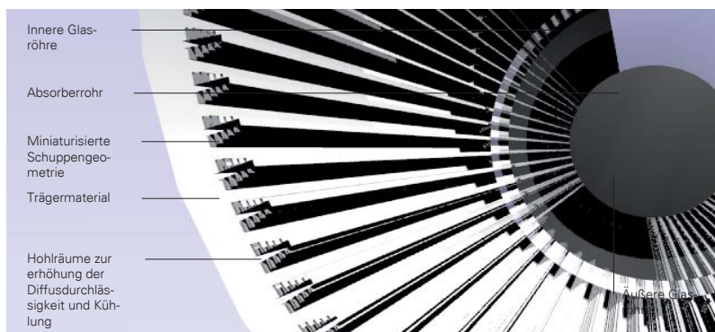
Abb. 3.1.16: 3D-Detaildarstellung einer optimierten Reflektorfläche nach dem Vorbild des Schuppentyps I
