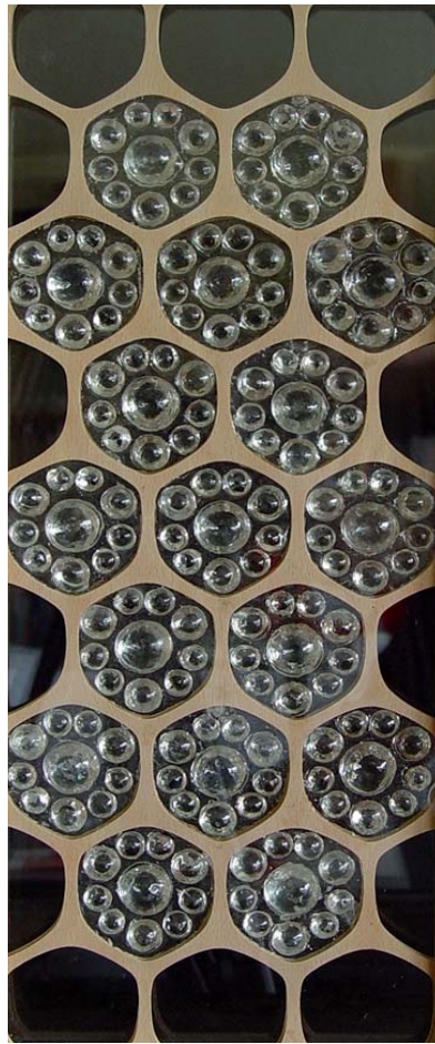
Abb. 3.4.11: Modellausschnitt einer autosensitiven Verschattungsstruktur im Überblick
