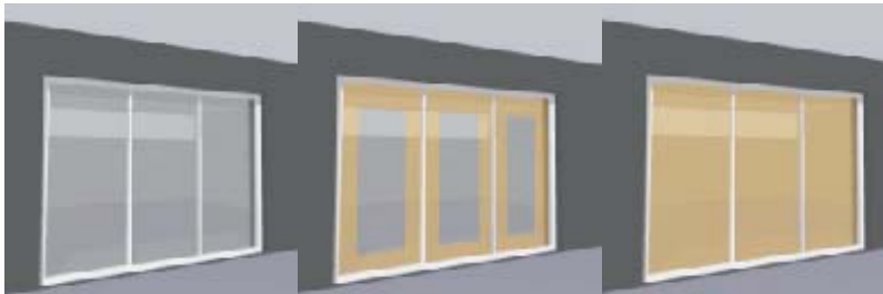
Abb. 4.3.9: Fassadenelemente trüben graduell vom Rahmenbereich in die Mitte des Elementes ein
