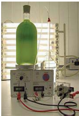
Abb. 4.2.11: Algenreaktor im Testlabor
