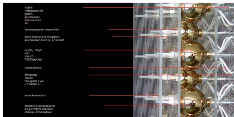
Abb. 3.6.13: Systematischer Aufbau des Versuchsmodells
