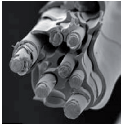
Abb. 2.3.9: REM-Aufnahme: Aufbau eines Stranges aus unterschiedlich grossen Fasern; 50 \mu\text{m}
