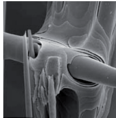
Abb.2.3.8: REM-Aufnahme: Knotenpunkte der Gitterstruktur; 100 \mu\text{m}
