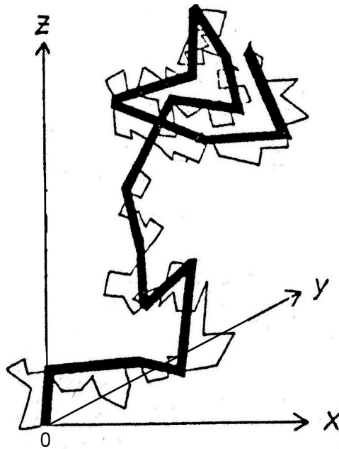
Abb. 2: Schematische Darstellung einer Polymerkette mit n Kettensegmenten und die Näherung durch die Irrflugkette [21] mit n_K Kettensegmenten, wobei n_K \ll n und l_K \gg l .
