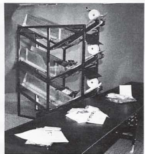
3: Tragendes Element der einzelnen Dispenser, hier eine Mehr-Level-Ausführung, ist eine leichtbauende Rahmenkonstruktion mit integrierten pneumatischen wie elektrischen Systemeinheiten
