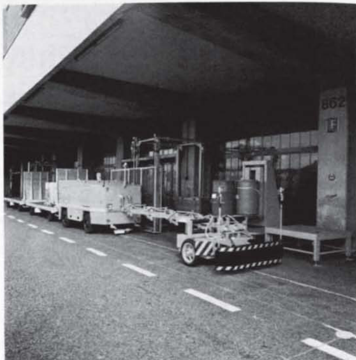
Abb. 4: Automatischer Schleppzug an der Beladestation für palettierte Güter. Kennzeichnend für das System sind der Sicherheitsvorwagen und der eigentliche Schlepper mit batteriebetriebenen Elektromotoren
