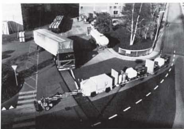
Bild 3: Schwerlast-FTS beim Überqueren einer Kreuzung mit Schienenanlagen.
