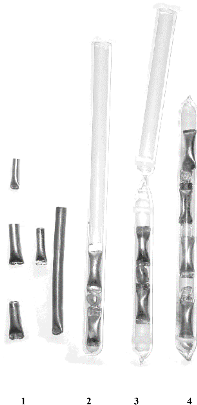
Abb. 2: Als Reaktionsgefäße verwendete Metallampullen (Niob, Tantal, Platin-Iridium-Legierung und Kupfer) (1); in Kieselglas eingeschmolzene Metallkapseln (2 – 4)
