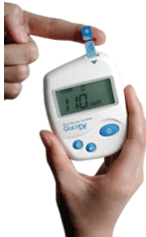
Abbildung 1: Glukose-Biosensor der Firma Allmedicus (An Yang, Korea; http://www.allmedicus.com )
