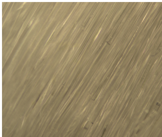
Muffelofen / Probenserie 1 / 100x / Fasern / 1h / 750 °C
