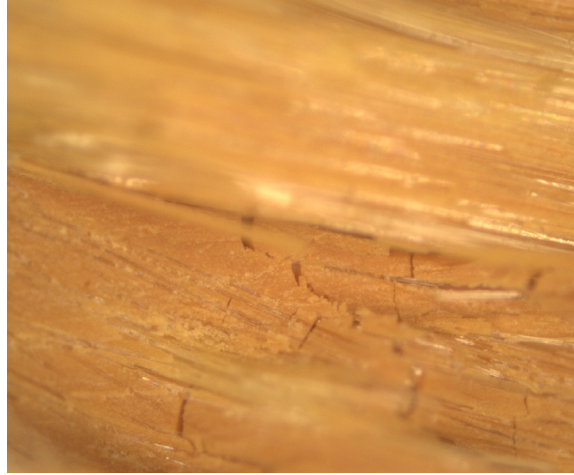
Zwick/Roell / Probe 2 / 50x / Rissfläche / Raumtemperatur
