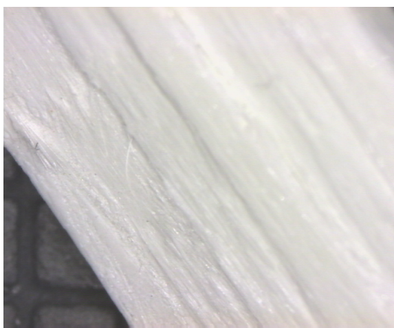
Zwick/Roell / Probe 3 / 16x / Rissbildung in Rovinglage / Raumtemperatur
