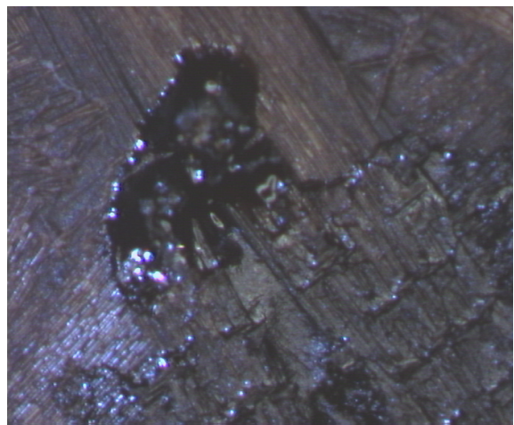
DMA / 66x / Musterbildung im Harz durch den Auflagebereich (Dualcantilever)
