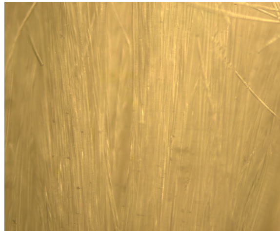
Muffelofen / Probeserie1 / 100x / ud 0 Schicht mit kleinen Einschlüssen
