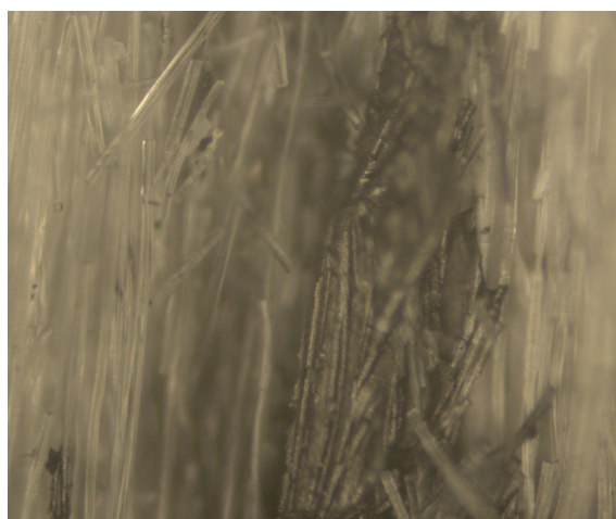
Muffelofen / Probenserie 2 / 100x / Mitte der Probe mit Marmorisierung / 1h / 650 °C
