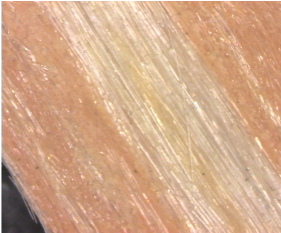
Probenstück GF-Phenolharz / 25x / Oberfläche / Raumtemperatur
