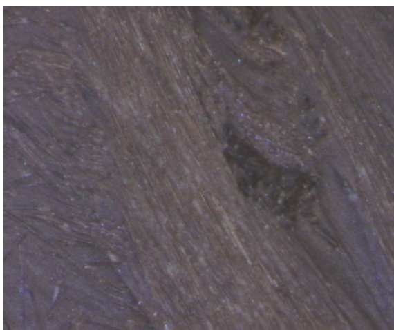
DMA / 60x / Bruchfläche oder Hohlraum
