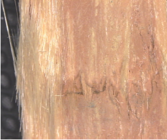
Zwick/Roell / Probe 2 / 12x / Riss über die Querschnittshöhe / Raumtemperatur
