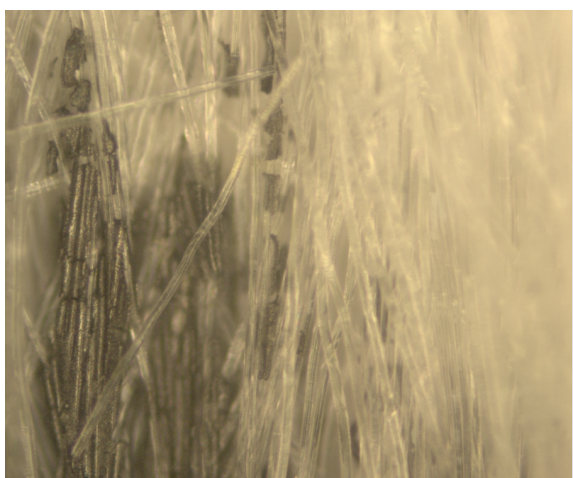
Muffelofen / Probenserie 2 / 100x / Mitte der Probe mit Marmorisierung / 1h / 650 °C
