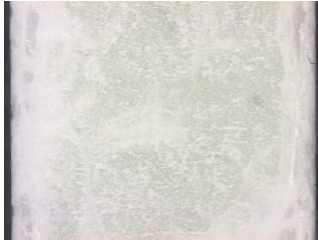
Abb 5.1 Ausschnitt über den Querschnitt einer Polyesterprobe mit homogenem Aufbau
