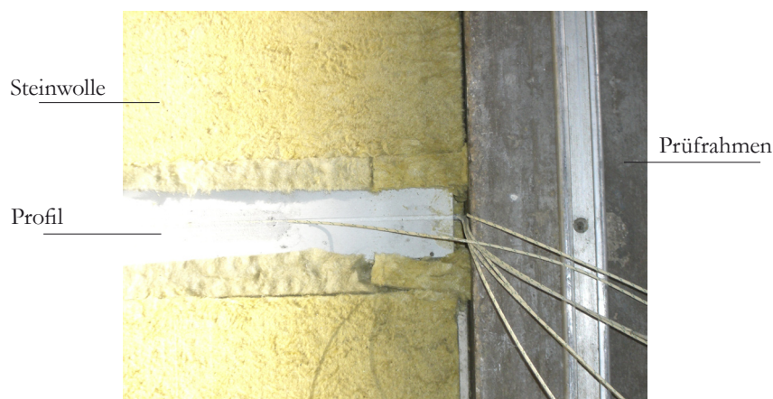
Abb. 10.14 Auflagerbereich mit herausgeführten Thermoelementen
