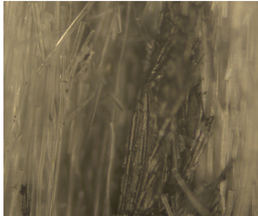
Abb. 5.4 Mikroskopieaufnahme der Marmorierung in einer GF-Phenolharzprobe
