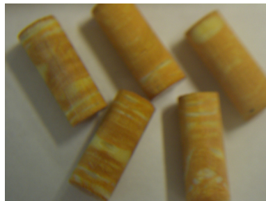
Abb. 8.57 GF-Phenolharzprobekörper der DSC- und TGA-Messung über die Querschnittshöhe
