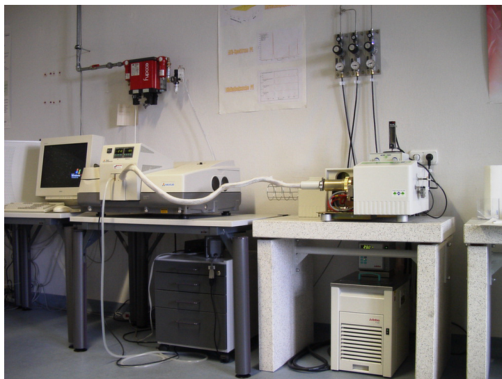
Abb. 6.10 Kopplung der Thermogravimetrie mit der Infrarot-Messzelle über eine Transferleitung und dem Temperiergerät unterhalb des TGA-Messmoduls
