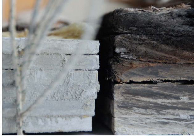
Abb. 10.20 Querschnittsveränderung der Höhe durch thermische Belastung
