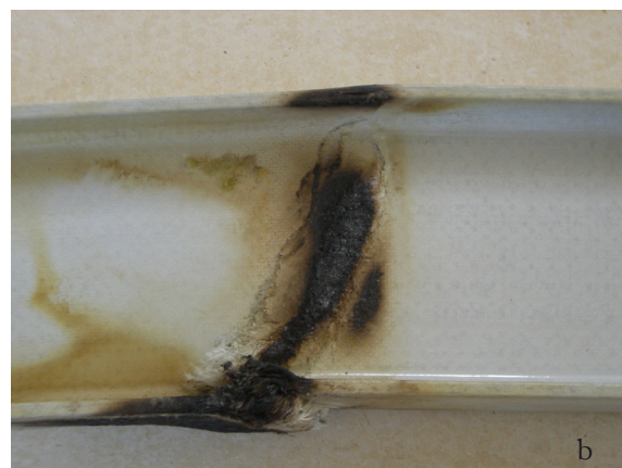
Abb. 9.33 Versagensstellen im Druckflansch am Übergangsbereich des Raumabschlusses, a) Querschnitt b) Seitenansicht
