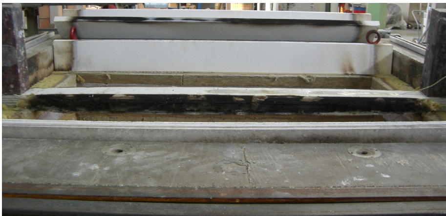
Abb. 10.15 Profil nach dem Brandversuch über der Ofenöffnung
