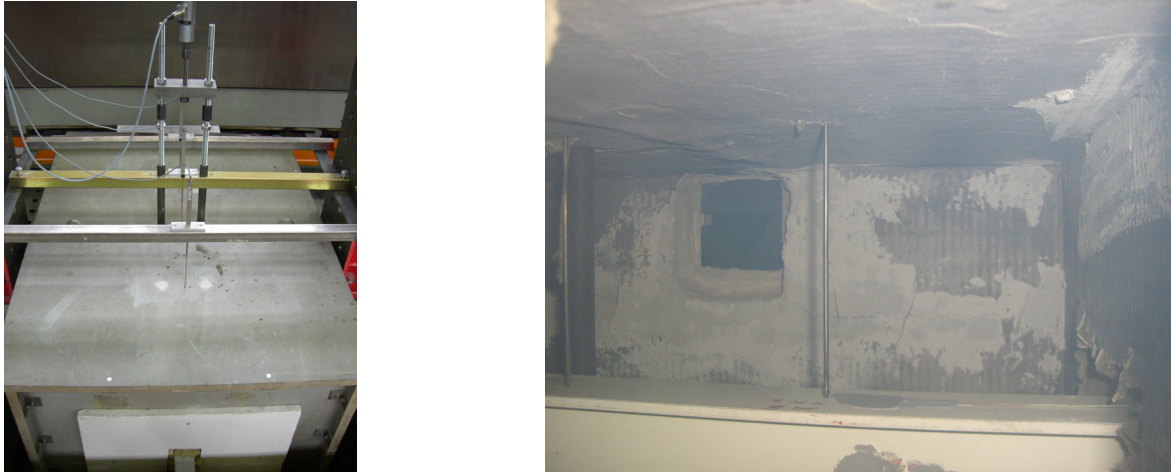
Abb. 9.7 Konstruktion zur Wegmesserfixierung an den Viertelpunkten, Aufnahme der Wegaufnehmer auf dem Profil an den Messstellen II und III
