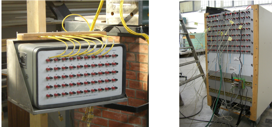
Abb. 9.9 Messbox der Ofentemperaturen und Rückseite der Messbox zur Aufnahme der Temperaturen des Profils
