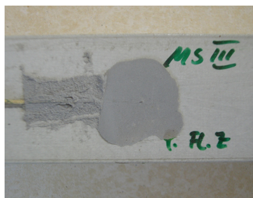
Abb. 9.14 Verklebung der Messpunkte und das Ergebnis mit der flächenbündigen Messstelle MIII des oberen Flansches
