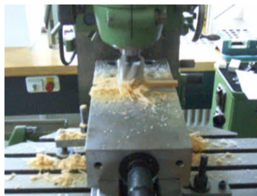
Abb. 3.2 Vorlauf der Oberfräse zur Querschnittsreduktion eines glasfaserverstärkten Phenolharz-Probekörpers 50 x 10 x 2 mm
