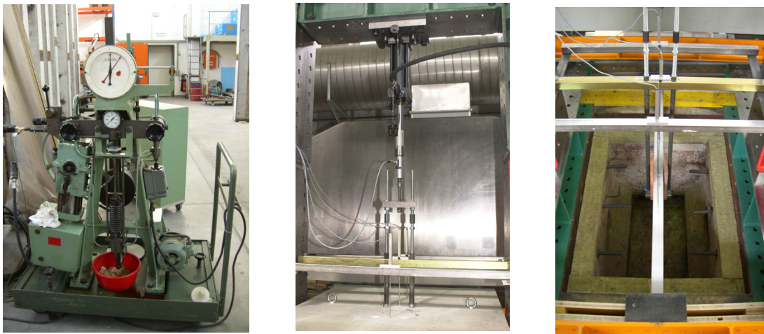
Abb. 9.6 Amsler Pendelmanometer mit Druckleitung zum Prüfzylinder, Belastungseinrichtung außerhalb des Raumabschlusses, Zugeinrichtung ohne Raumabschluss
