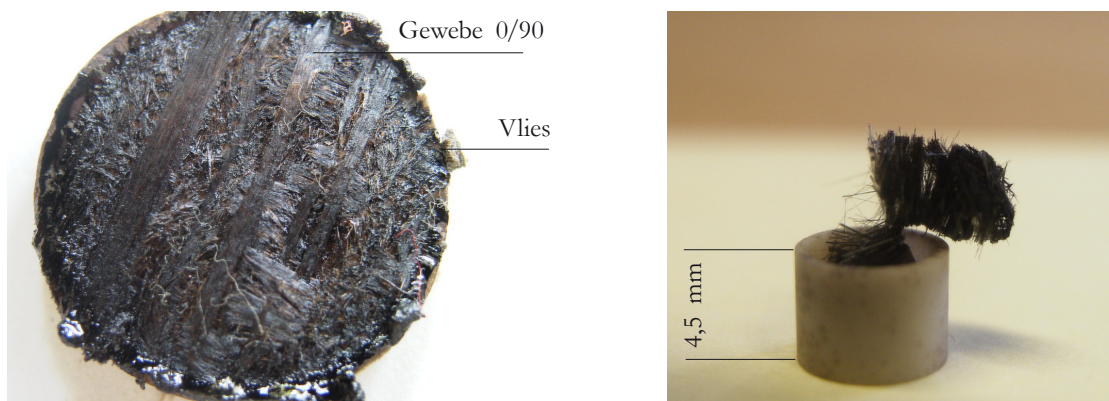
Abb. 5.2 Links eine thermisch freigelegte, zweifache Vlies- und Gewebeschicht an der Oberfläche, Rechts eine TGA-Probe nach der Messung unter Stickstoff von ursprünglich 2,0 mm Dicke, Tiegelhöhe: 4,5 mm
