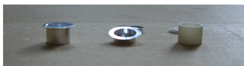
Abb. 6.8 Von links nach rechts: Aluminium Standard 100 µl ohne Noppen und Deckel, Aluminium Standard 40 µl mit Noppen und Deckel, Alu-Oxide 40 µl ohne Noppen mit Deckel
