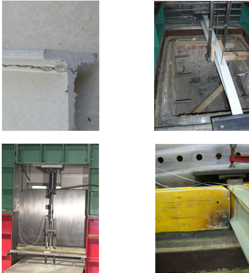
Abb. 9.10 Versagen des Profils im Auflagerbereich, Auskippen des Profils bei erhöhter Belastung, Aussteifungskonstruktion zur Verminderung translatorischer Bewegungen, Aussteifungen im Auflagerbereich
