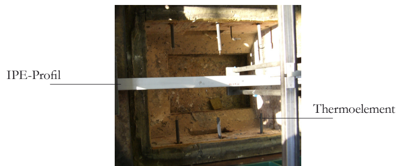
Abb. 9.5 Aufsicht auf den KVO mit den Thermolementen zur Gasraumtemperaturmessung und der Profilführung über die Ofenöffnung
