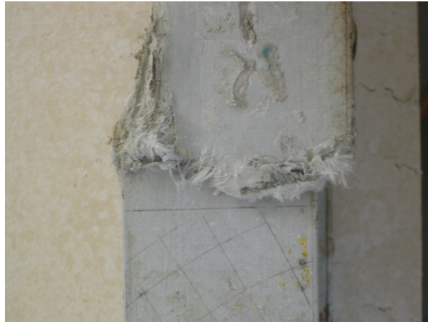
Abb. 6.2 Druckbereich eines GF-UP-Hohlkastenprofils (100 x 100 x 10 mm) unter Drei-Punkt-Biegung
