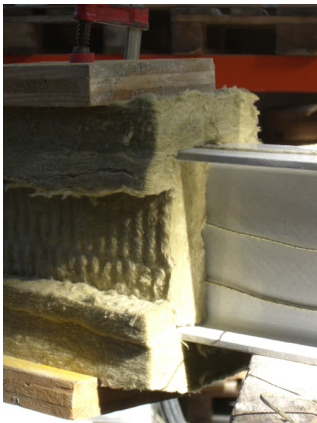
Abb. 9.31 Ummantelung des Profils IPE 120 mit Steinwolle; Ansicht des steinwollverkleideten und drahtverbügelten Trägers
