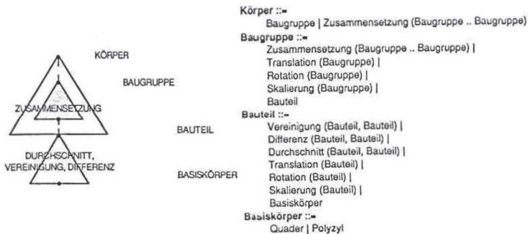
Abb. 2.3: Struktur der modellierbaren Körper
