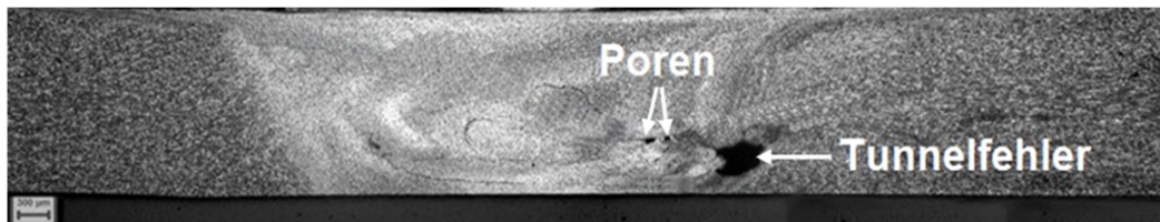
Bild 7: Tunnelfehler an der Gleichlaufseite /SHE06/
