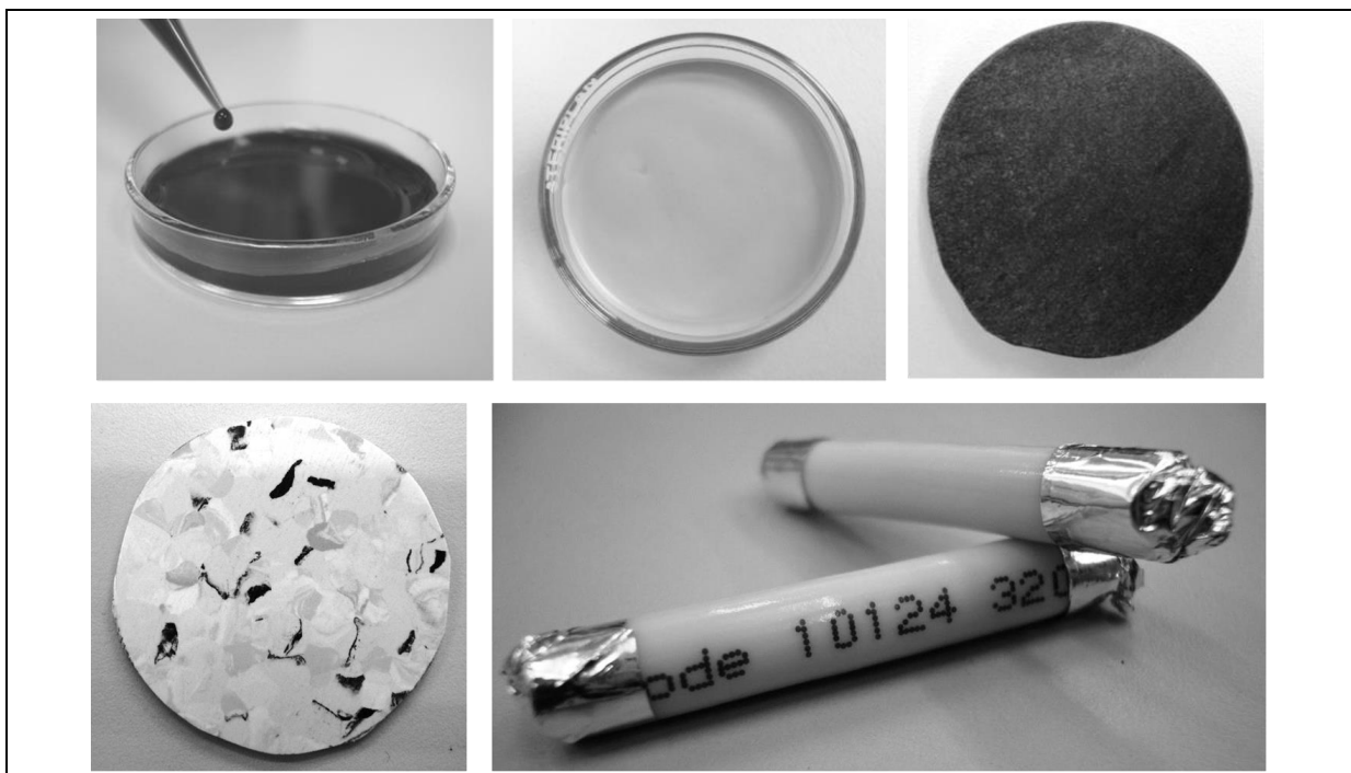
Abbildung 5-4 Verschiedene Proben. Oben links: Schmieröl. Oben Mitte: Fertig in eine Glaspetrischale appliziertes Epoxid-Reaktivsystem. Oben rechts: Ausgefrästes Kunststoff-Formstück. Unten links: Ausgestanzte Bahnware. Unten rechts: Fertig präparierte Kabelstücke.
