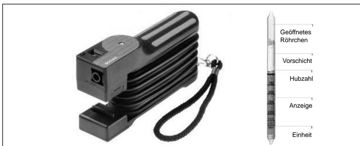
Abbildung 4-1 links: Dräger-accuro Probenahmepumpe für Dräger-Röhrchen. Rechts: Allgemeine Erläuterungen zur Beschriftung der Dräger-Röhrchen. Bildquelle: (Dräger Safety AG & Co. KGaA 2009)
