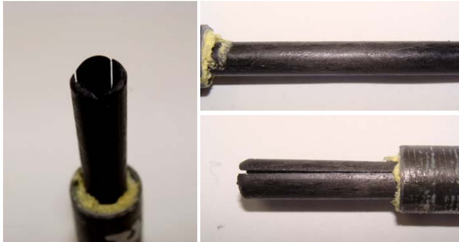
Abbildung 3.3: Durchzwängung durch den Bewehrungskanal bei Rippentiefe ca. 1 mm
