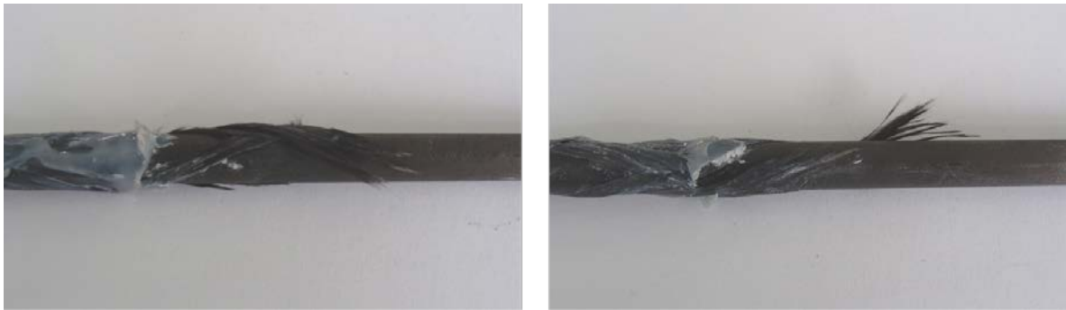
Abbildung 3.1: Versagen von Stabprofilen mittels Umwicklung
