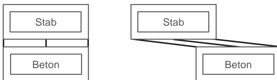
Abbildung 4.12: Prinzip der Kontaktfläche [116]
