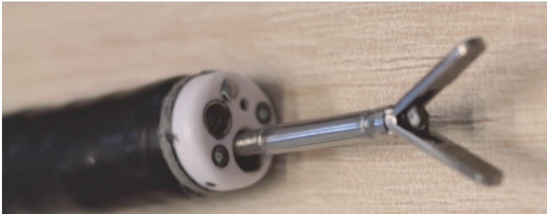
Abbildung 61: Flexibles Instrument bei der Anwendung im Arbeitskanal in einem flexiblen Endoskop
