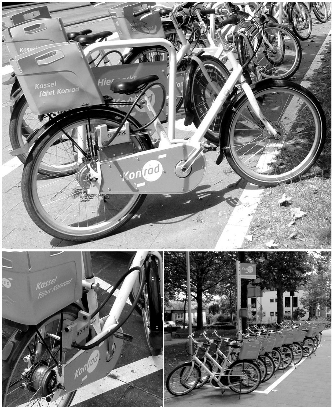
Abbildung 15: Leihrad mit Schließsystem, Schließmechanismus und Station von „Konrad“ in Kassel (eigene Aufnahmen).
