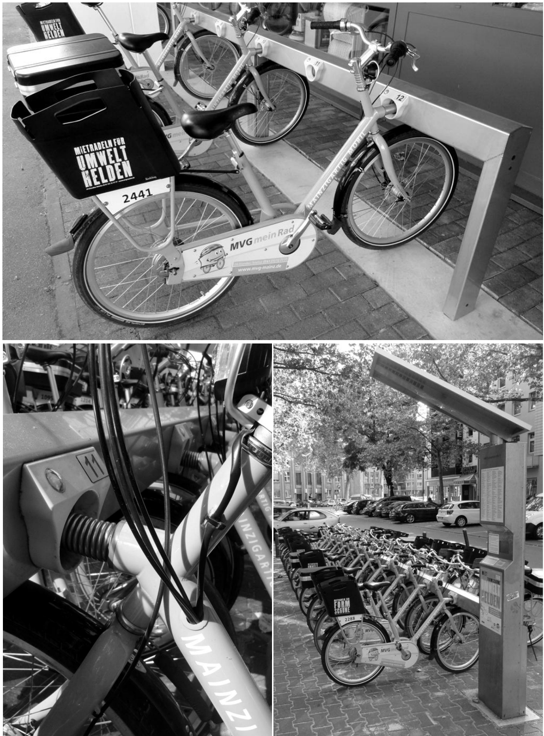
Abbildung 16: Leihrad in Station, Kupplungsmechanik und Station mit Terminal von „MVGmeinRad“ in Mainz (eigene Aufnahmen).
