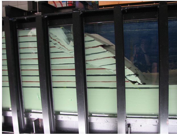
Abb. 4.6: Böschungskörper mit sichtbarem Scherband nach dem Versagen; der hier gezeigte Versuch stellt eine spezifische Demonstration eines Böschungsexperimentes dar und wurde nicht in die quantitative Auswertung mit einbezogen, da die gefärbten Sandschichten das Materialverhalten des Gesamtkörpers leicht veränderten.
