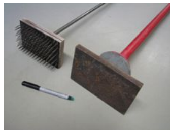
Abb. 3.5: Geräte, mit denen die Füllungsschichten verdichtet und bearbeitet wurden, links Nagelbrettstamper und rechts schwerer Stampfer.
