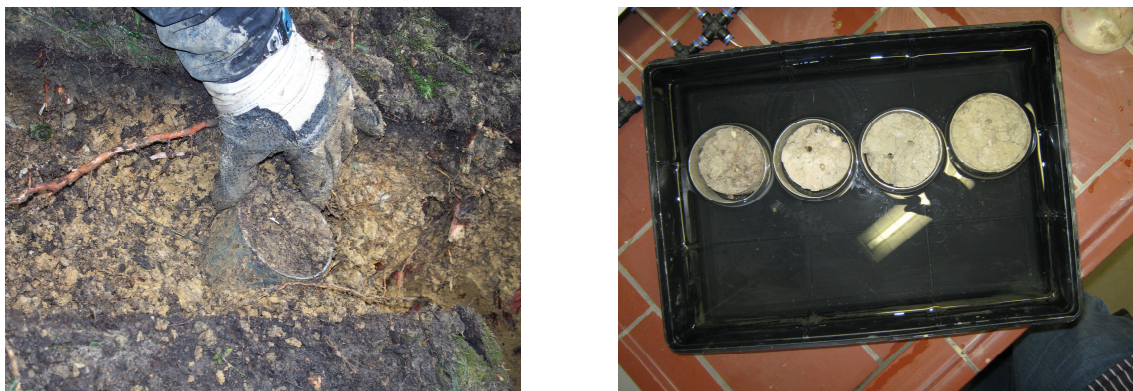
Abb. 2.16: Links: Bodenprobennahme mit einem Kleinzylinder ( 250 \text{ cm}^3 ) in dem oberflächennahen Modulprobenbereich A am Heumöser Hang; rechts: Zylinderproben mit 250 \text{ cm}^3 Volumen vom Heumöser Hang aus den Tiefen A bis D (von links nach rechts) stehend in einem Wasserbad zur Probenwiederaufsättigung (nach starker Austrocknung der Proben nach Durchführung von HYPROP-Messungen).
