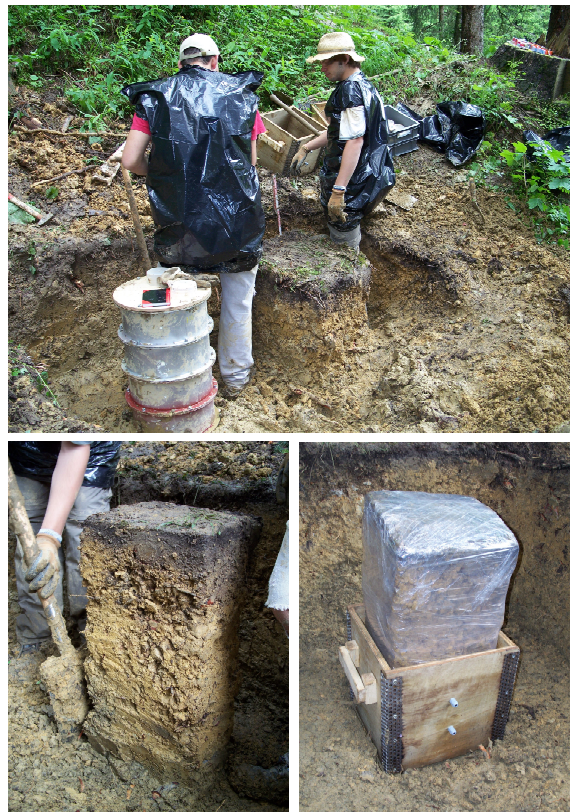
Abb. 2.4: Oben eine Fotoaufnahme des Bodenanschnitts während der Freilegung der Bodensäulen, die zylindrische Säule ist fertig freigegeben und mit den Stahl-Außenhüllenmodulen überzogen (oben links), 50 cm rechts davon findet gerade die Vorbereitung der Freilegung der quadratischen Bodensäule statt (grob freigegeben); unten links dargestellt die quadratische Bodensäule kurz vor dem Erreichen der exakten Abmessungen; unten rechts die mit Folien eingewickelte Säule mit einem übergestülpten Holzmodul (der sichtbare zwei Zentimeter-Spalt zwischen Holzmodul und Säulenaußenhülle wurde später mit Montageschaum gefüllt).
