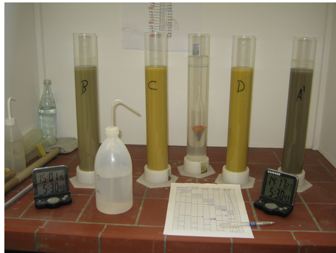
Abb. 2.9: Momentaufnahme zu den Aräometer-Messungen an den Bodenproben A bis D (entsprechend von oben nach unten im Bodenprofil), mit Färbungen des Schlämwwassers von dunkelgrau nach hellgelb.
