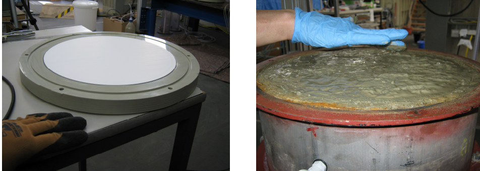
Abb. A.4: Links: Saugplattenmodul für die Befestigung am unteren Rand; rechts: sichtbare untere Grundfläche der Bodensäule (Bodensäule steht auf dem Kopf) mit Einschleimsschicht kurz vor dem Aufpressen des Saugplattenmoduls und der Befestigung am unteren Flansch.
