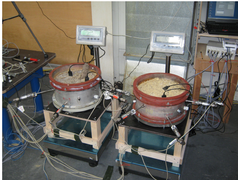
Abb. A.7: In der VEGAS-Versuchshalle aufgestellte Bodensäulenviertelmodule während eines Evaporationsexperiments; die zwei 15 cm hohen Module wurden zeitgleich auf jeweils eigener Plattformwaage stehend der freien Evaporation ausgesetzt; die Tensiometer stehen waagrecht aus den Modulen heraus; rechts oben im Foto Tensiometerdatenerfassungs-Box und Computer mit angeschlossenen Waagen zur permanenten Gewichtswerteerfassung.
