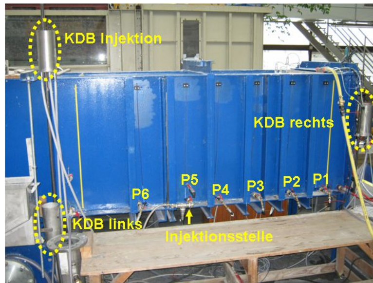
Abb. 4.2: Rückansicht des Containers mit Konstant-Wasserdruck Behältern (KDB) und Drucktransmittern für die Messung des Porenwasserdrucks (P1 bis P6).
