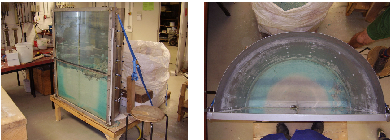
Abb. 3.9: Entnahme der Sandfüllung nach dem letzten Versuch, bei dem zuerst blaugefärbtes Wasser und anschließend Klarwasser in die Makropore injiziert wurde, um die radialsymmetrische Wasserausbreitung in der Sandmatrix zu visualisieren.
