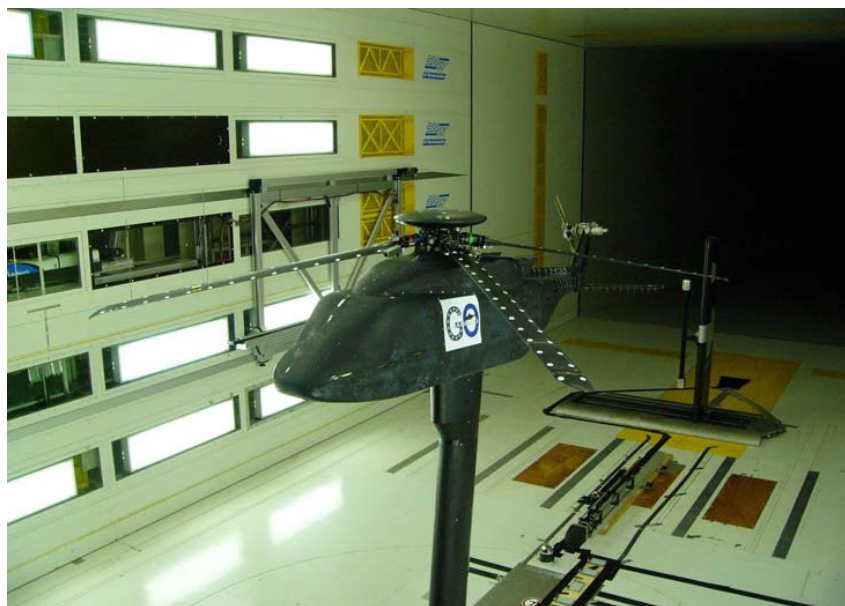
Bild 2.13: Mach-skalierte Gesamthubschrauberkonfiguration der GOAHEAD Messkampagne mit 7AD Hauptrotor im Windkanal DNW-LLF, Photo aus SCHWARZ UND PAHLKE [148].
