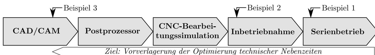
Abbildung 7.1: Einordnung der Beispiele im Entstehungsprozess eines NC-Programms
