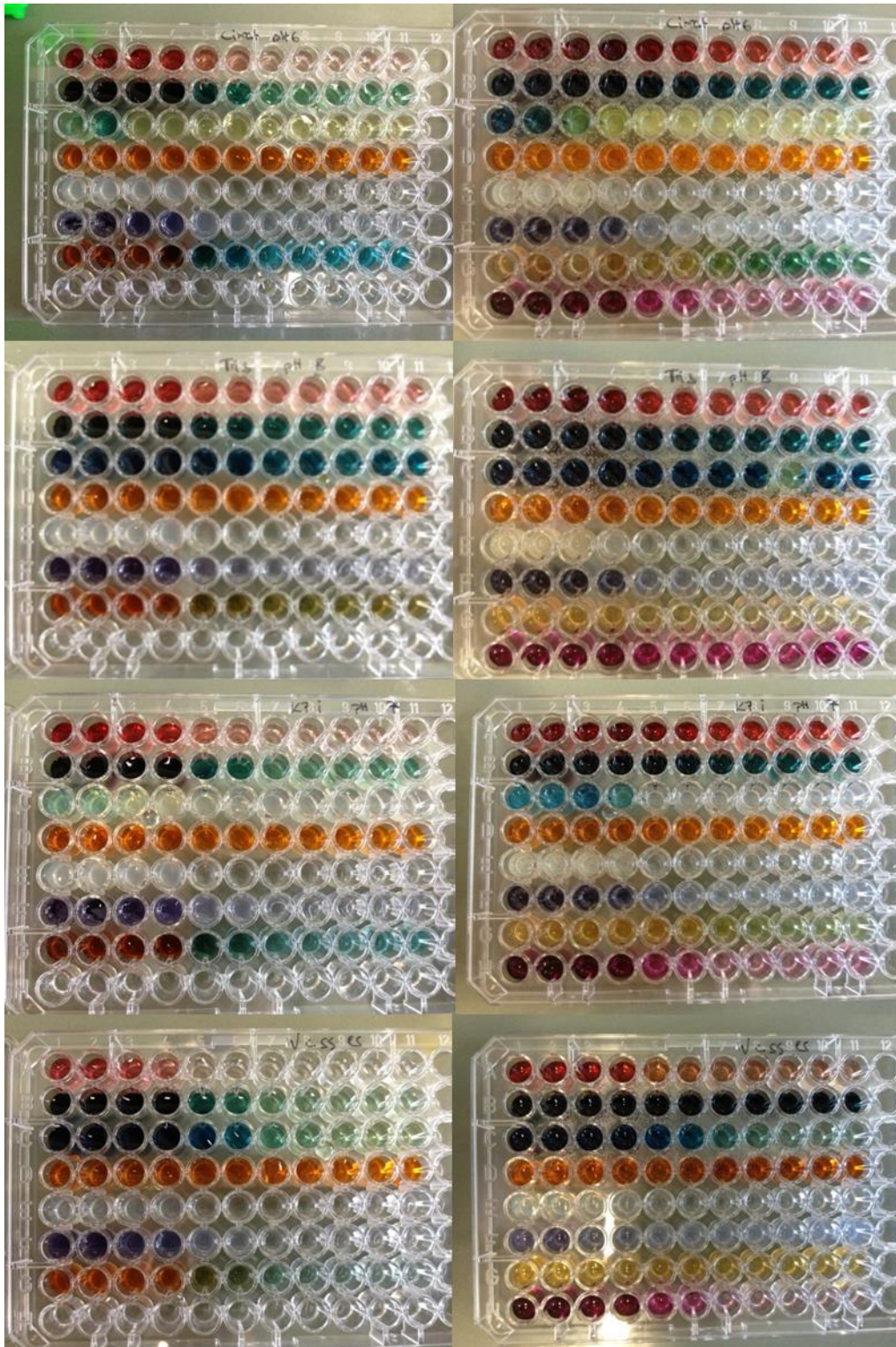
Abbildung 50 Links: Die unterschiedlichen getesteten Screenings von oben nach unten: Citrat-, TrisHCl-, Kaliumphosphatpuffer und 1% NaCl-Wasser-Lösung, nach 10 min Reaktionszeit bei 35 °C im Inkubator bei 180 rpm. Rechts: Identische Platte nach 60 min. Verfahren von oben nach unten: 1. 4-Aminoantipyrin + Vanillinsäure, 2. ABTS, 3. MBTH + Fe(III) + Sulfaminsäure, 4. Referenz 5. 2-Naphthol, 6. 4-Chlornaphthol, 7. 3,3', 5, 5'-Tetramethylbenzidin, 8. Purpald. Methanolkonzentrationen von links nach rechts: 12,5 mM, 6,25 mM, 1,25 mM, 0,62 mM, 0,12 mM, 0,06 mM, 0,01 mM, 0,006 mM, 0,001 mM, 0,0001 mM, 0 mM.
