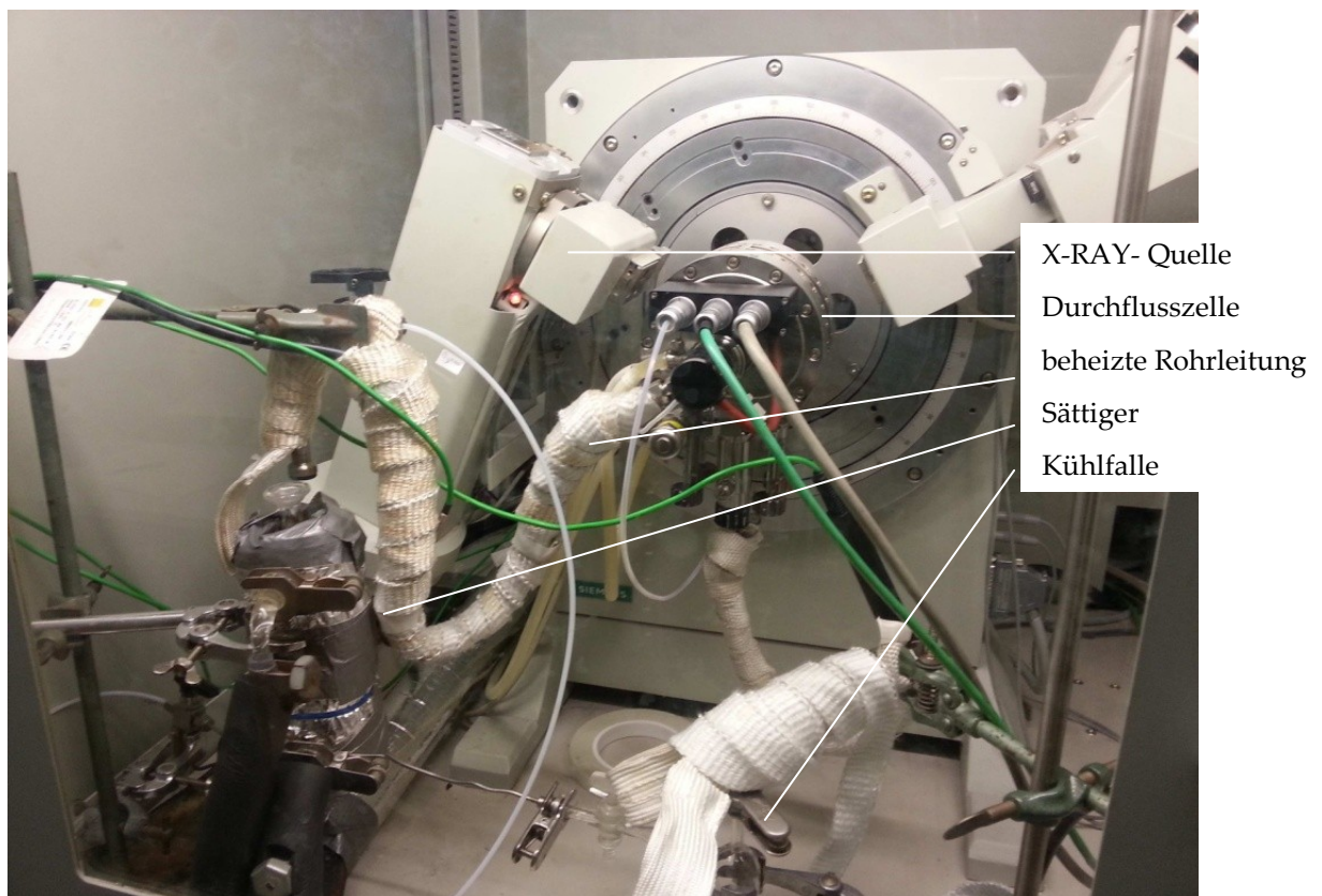
Abb. 3.12: Fotografie des Aufbaus für in-situ Röntgenpulverdiffraktometrie.
