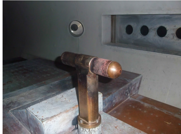
Abbildung 3.3.2.: Schnittansicht des Enthalpiesondenkopfs[59] und Versuchsaufbau im PWK3
