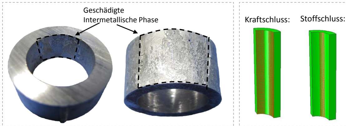
a) Abbildung 4.34: a) Darstellung eines feuerverzinkten Stahlrings nach dem Ausdruckversuch mit geschädigter intermetallischer Phase, b) Kraft- und Stoffschlussbereich im 3D-Ausdruckmodell aufgezeigt am Aluminiumgussbereich
