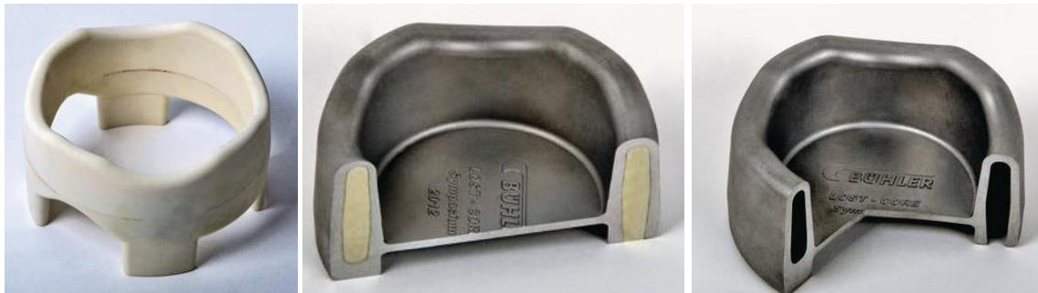
a) b) c) Abbildung 2.11: Bühler Pilotbauteil [54]: a) Salzkern Pilotbauteil, b) Schnitt durch Pilotbauteil mit sichtbarem Salzkern, c) Schnitt durch Pilotbauteil entkernt
