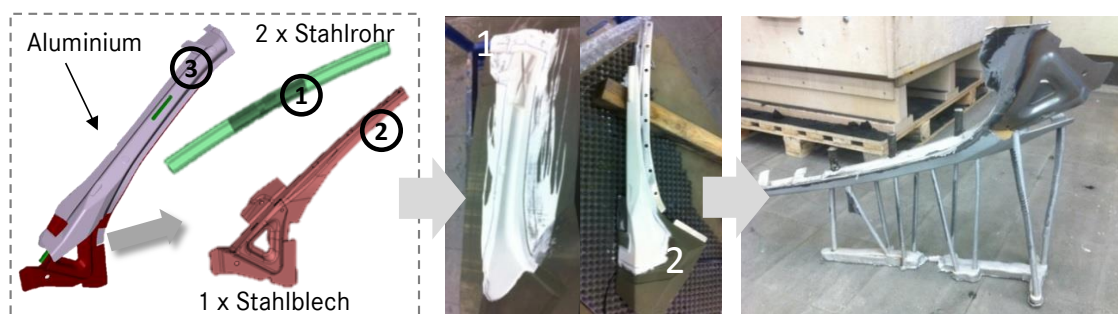
a) Abbildung 6.1: a) Verbundguss-A-Säulenkonzept mit Darstellung der zwei verwendeten Stahlrohre, des Stahlblechs und des Aluminiumgussbereichs; b) Sandform und Sandkern; c) Gussrohling der Verbundgussssäule mit Angussystem und Speisern
