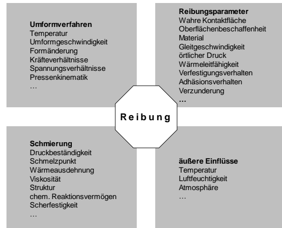
Abbildung 9: Einflussgrößen auf die Reibung nach [Li95]
