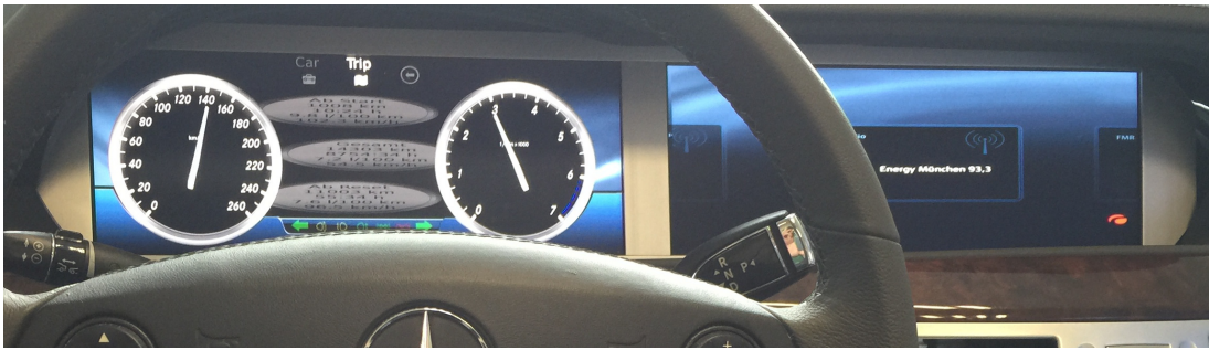
Abbildung 5.12.: Szenario (S4) mit Radioanwendung auf der Anzeige der HU
