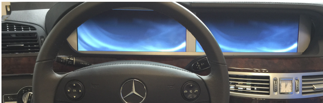
Abbildung 5.8.: Ausgangssituation (S0) mit gestarteten virtuellen Maschinen für die Kombiinstrumente und der HU
