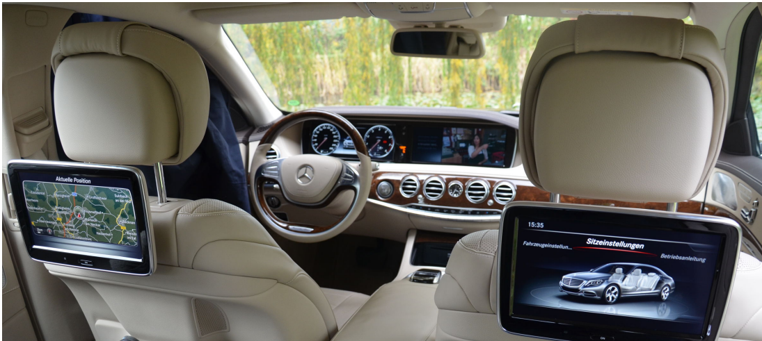
Abbildung 1.3.: Vier verbaute Anzeigen in einem Mercedes-Benz S 500
