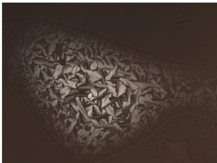
Abbildung 30: sphärolitische Textur der Mesophase von 1-Methyl-3-(3',4',5'-trisdodecyloxy-benzyl)-imidazoliumbromid 103 , T = 83\text{ }^{\circ}\text{C} , Vergrößerung: 200x
