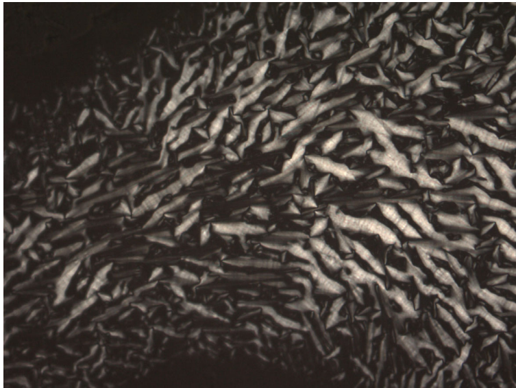
Abbildung 27: Fokal-konische Fächertextur der Sm-Phase von 1-Methyl-3-(4'-tetradecyloxy-benzyl)-imidazoliumbromid 96b , T = 92\text{ }^{\circ}\text{C} , Vergrößerung: 200x
