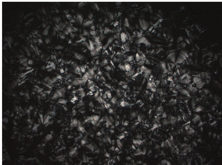
Abbildung 25: Fokal-konische Fächertextur der Sm-Phase von 4-Benzyl-1-octadecylpyridinium-bromid 79 , T = 36 °C, Vergrößerung: 200x
