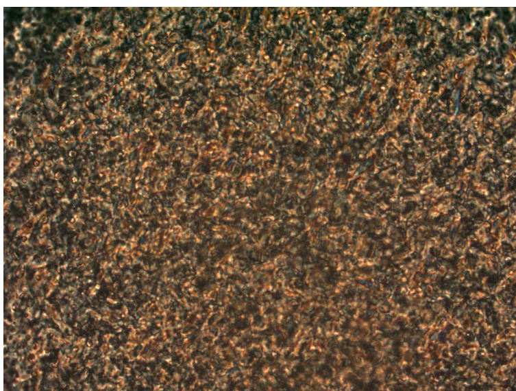
Abbildung 26: Fadentextur der N-Phase von 1-Methyl-3-(4'-tetradecyloxy-benzyl)-imidazoliumbromid 96b , T = 32 °C, Vergrößerung: 200x
