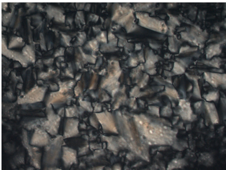
Abbildung 39: Fokal-konische Fächertextur der Sm-Phase von (3''S)-1-(5'-Citronel- loxycarbonyl-pentyl)-3-methylimidazoliumbromid 45 , T = 20 °C, Vergrößerung: 200x
