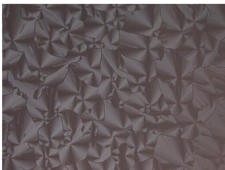
Abbildung 11: Fokal-konische Fächertextur der Sm-Phase von (3' R )-Citronellylpyridiniumbromid 14b , T = -56 °C, Vergrößerung: 200x
