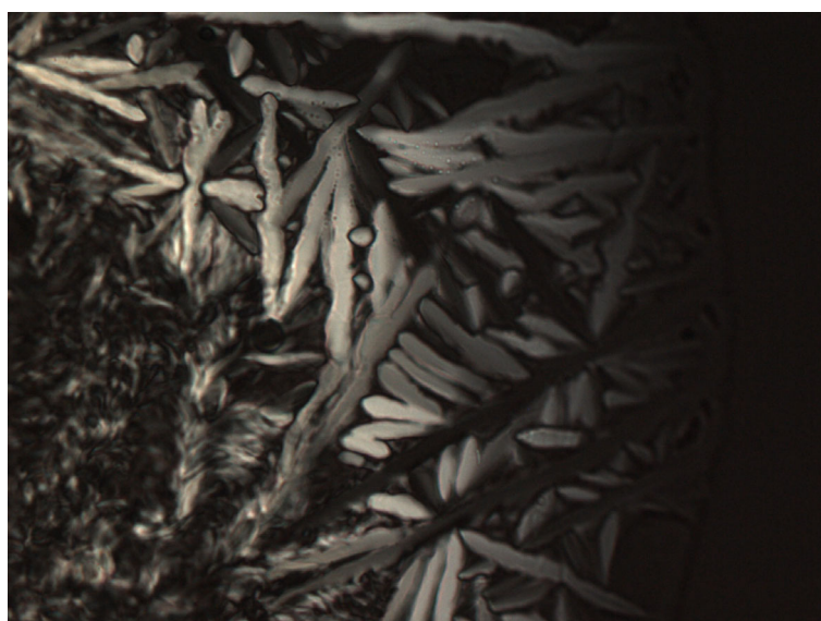
Abbildung 29: Bâtonnet Textur der Mesophase von 1-(3',4',5'-Tris-dodecyloxybenzyl)-pyridiniumbromid 102 , T = 80 °C, Vergrößerung: 200x
