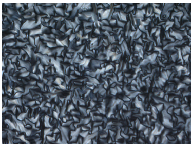
Abbildung 7: Fokal-konische Fächertextur der Sm-Phase von (3' R )-1-Citronellyl-3-methylimidazoliumchlorid 13a , T = - 18 °C, Vergrößerung: 200x
