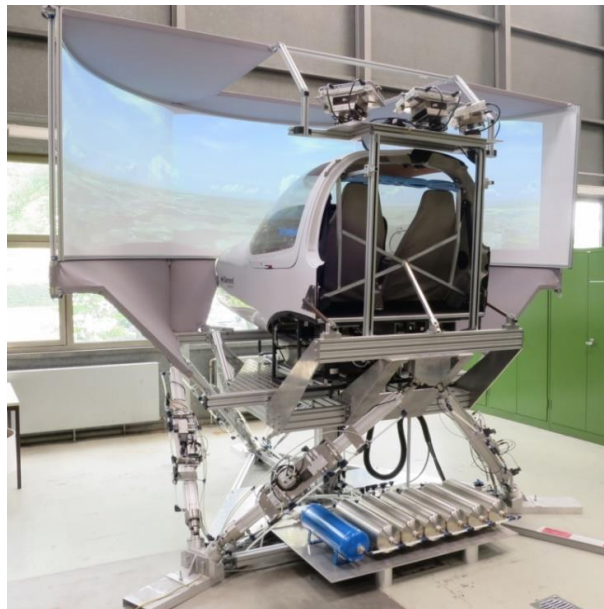
Abbildung 2.1: Flugsimulator mit paralleler Kinematik des Instituts für Systemdynamik der Universität Stuttgart (ISYS)
