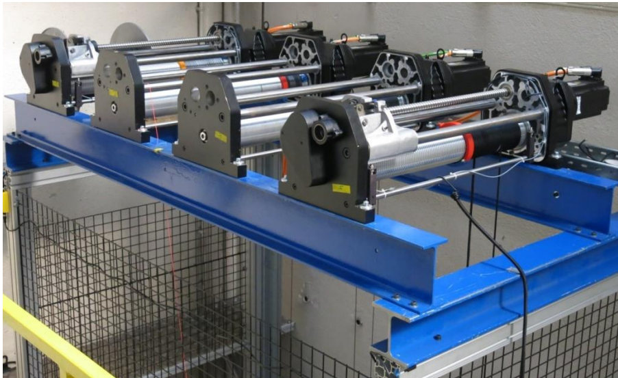
Abbildung 3.14: Windenantriebe des Hochdynamikprüfstands
