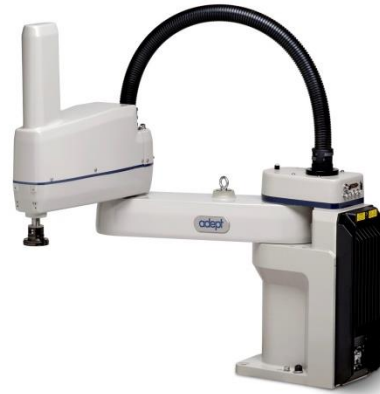
Abbildung 5.14: Beispiel für Roboter B: SCARA-Roboter für Flex-Picker-Aufgaben [144]
