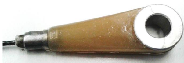
Abbildung 3.11: HIKE-Verguss an einem 2 mm HM-HT-Faserseil
