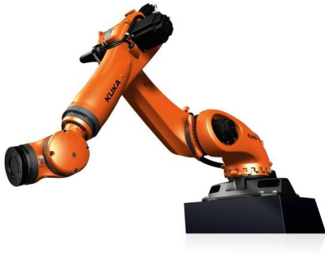
Abbildung 5.13: Beispiel für Roboter A: Klassischer 6-Achs-Industrieroboter [137]
