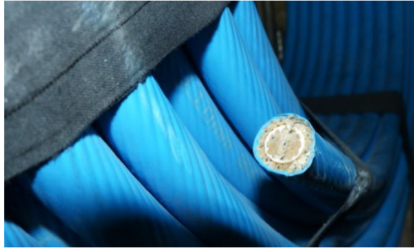
Abbildung 2.22: Aramidseil der Firma Schindler für den Einsatz in Aufzügen
