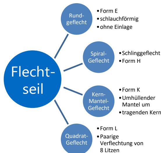
Abbildung 2.3: Übersicht über geflochtene Seilkonstruktionen i.A.a. [161]
