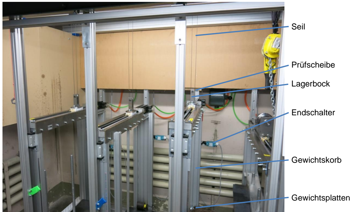
Abbildung 3.16: Gewichskörbe des Hochdynamikprüfstands mit Linearführungen, Schrägzugkompensation und Prüfscheiben
