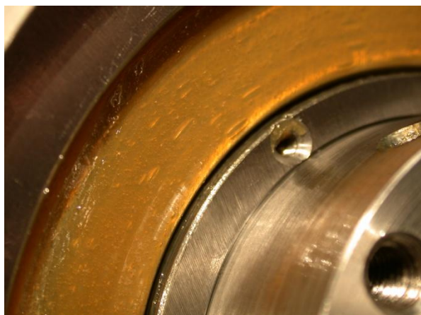
Bild 104: Lufteinschlüsse im Fett auf Stator
