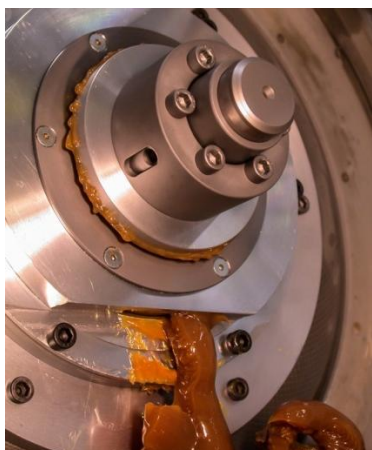
Bild 284: Fettabflussuntersuchung Dichtsystem ECO 04 - Fett A bei 500 min -1 - Ergebnis : gut
