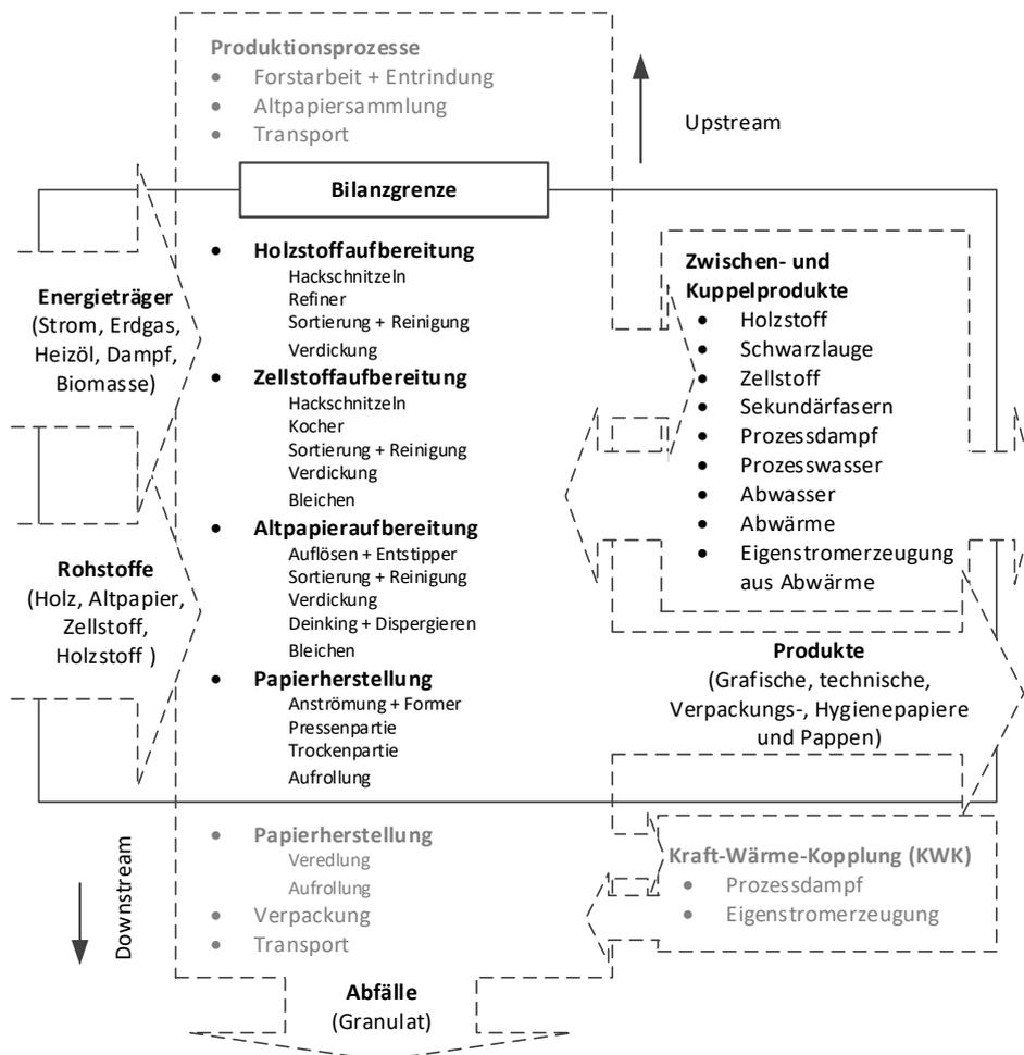
Abb. 5-2: Bilanzierte Produktionsprozesse und Produkt-, Energie- und Stoffströme in der Herstellung von Papier und Pappen in Deutschland
