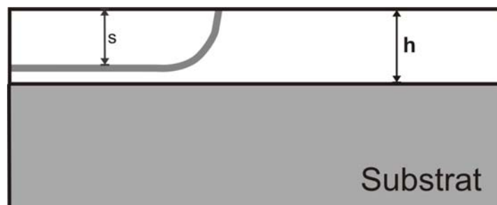
Abbildung 2-2: Schematische Darstellung einer dünnen Schicht mit der Dicke h und einer Versetzung, die sich an der Grenzfläche Substrat/Schicht mit dem Abstand h-s abgelegt hat. Die effektive Schichtdicke beträgt s .
