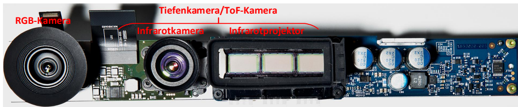
Abbildung 2.10: Hauptplatine der Kinect für Xbox One nach [Mia13]
