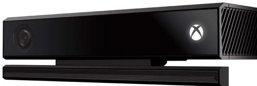
Abbildung 2.9: Kinect für Xbox One nach [Sar13]. Das obere Teil enthält die RGB-Kamera, Infrarotkamera und den Infrarotprojektor (von links nach rechts) und ist kippbar. Unten befindet sich das Mikrofon-Array.
