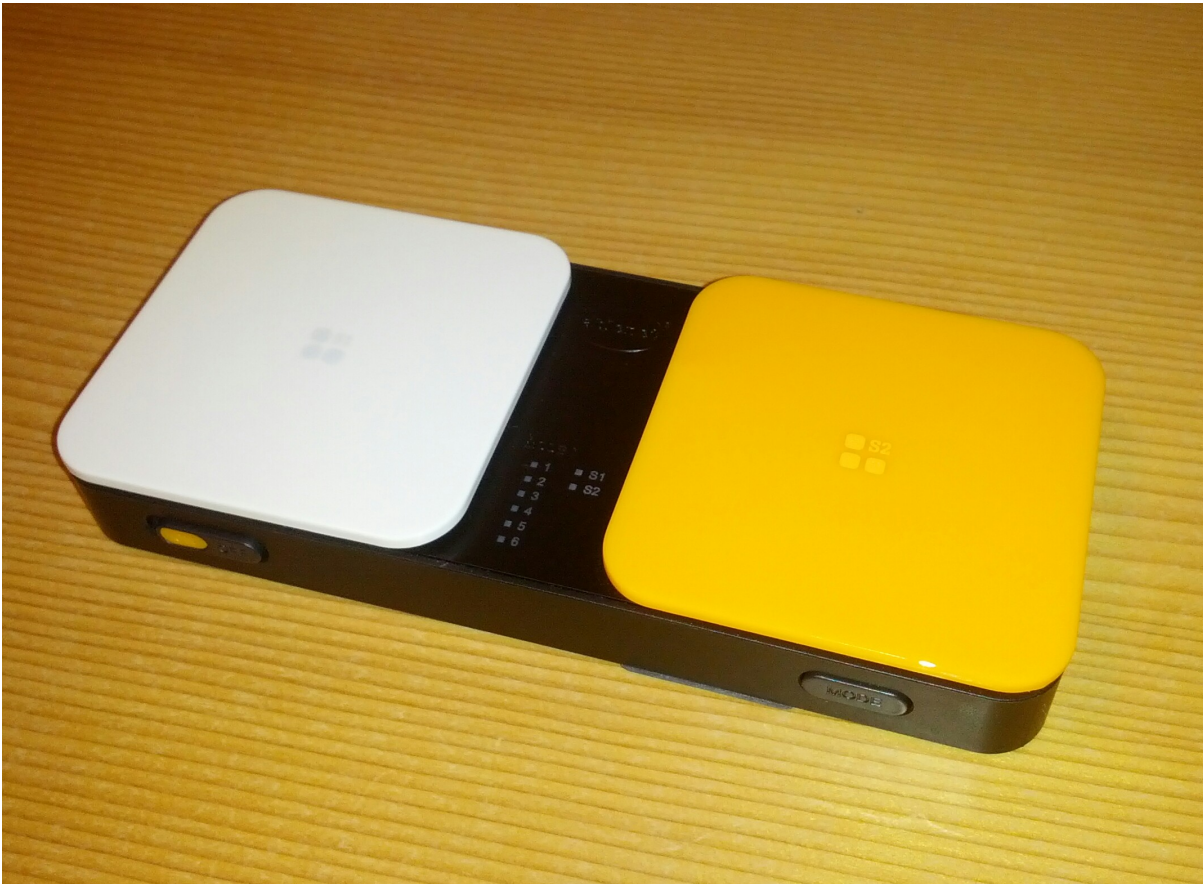
Abbildung 4.8.: Button Switch, der sich für das 1- und 2-Button-Scanning eignet.
