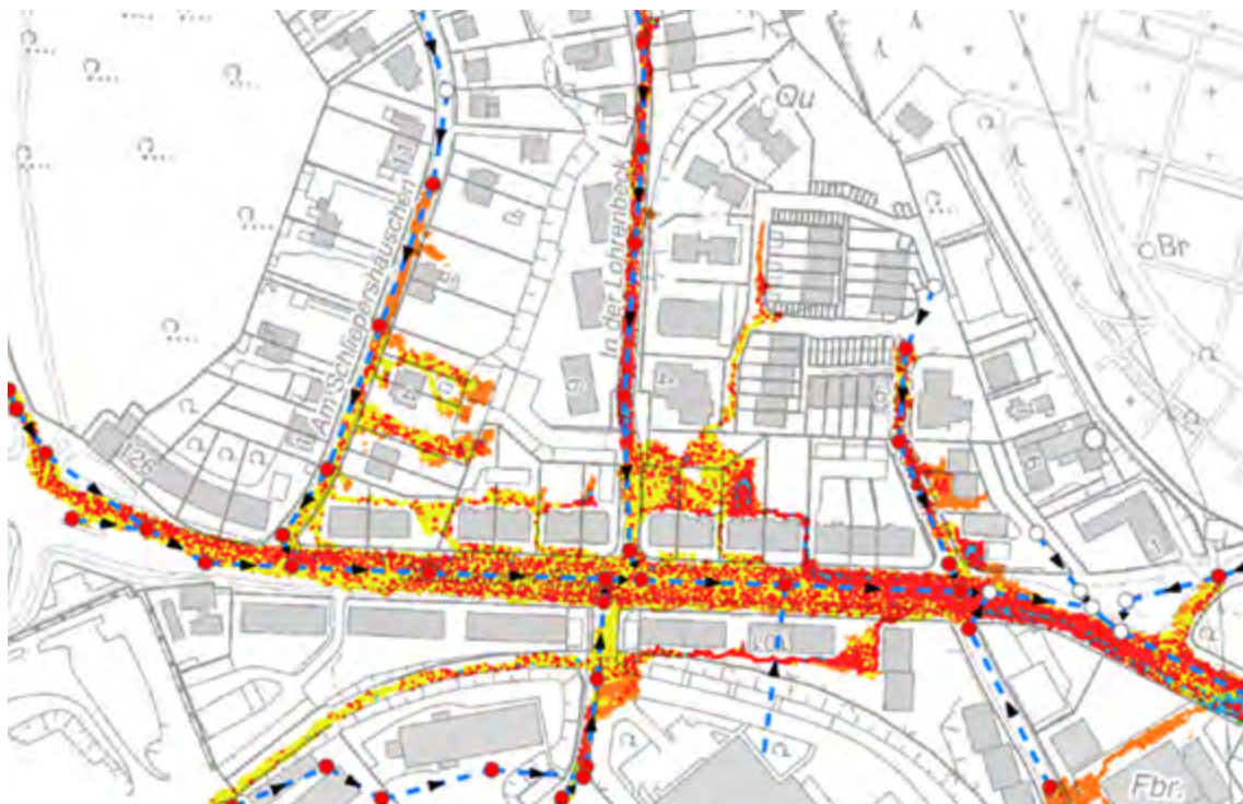
Abb. 28 Ergebnisse der Überflutungsberechnung mit und ohne Klimatrend (Dr. Pecher AG 2015)
