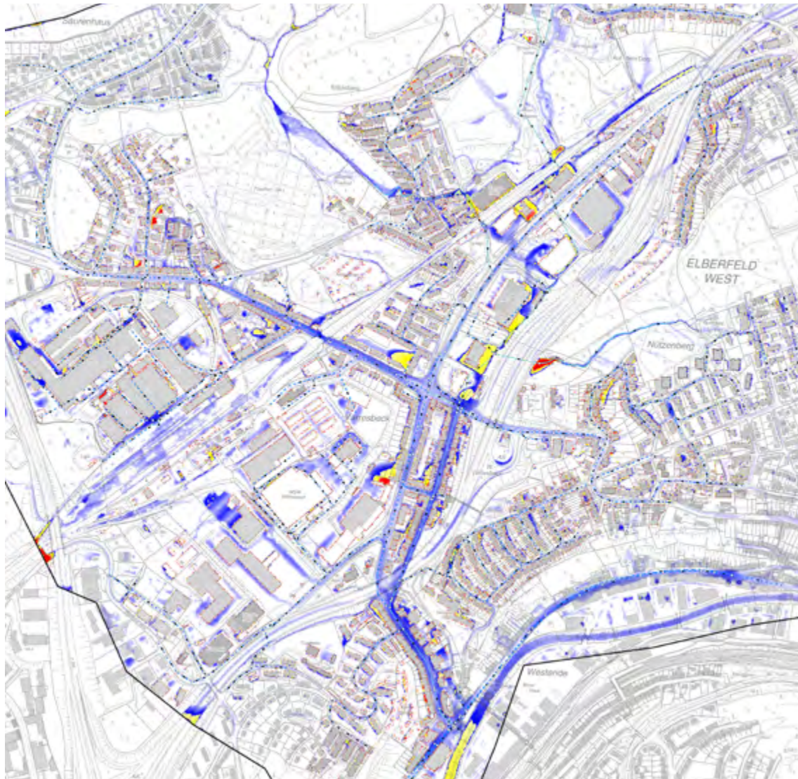
Abb. 97 Überflutungssimulation für das Modellgebiet im IST-Zustand für T=30a mit Abflussbildung über das Kanalnetz- und Oberflächenmodell. Als Ergebnis der einzelnen Berechnungen wurden jeweils die maximalen, während der Simulation aufgetretenen Wasserstände ausgewiesen (Dr. Pecher AG 2016)
