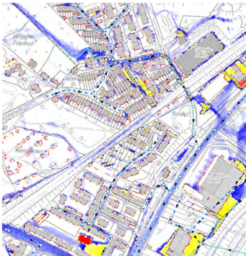
Abb. 121 Überflutungssimulation für das Fokusgebiet II nach Maßnahmenumsetzung für T=30a mit Abflussbildung über das Kanalnetzmodell (oben) und Abflussbildung über das Kanalnetz- und Oberflächenmodell (unten) (Dr. Pecher AG 2016)
