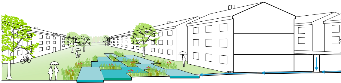
Abb. 128 Durch den Keller der Zeilenbebauung wird ein Rohr gelegt, so dass im Starkregenfall das Regenwasser sicher durch das Haus hindurch auf den Wasserplatz im Genossenschaftshof geleitet werden kann (ILPÖ 2016)
