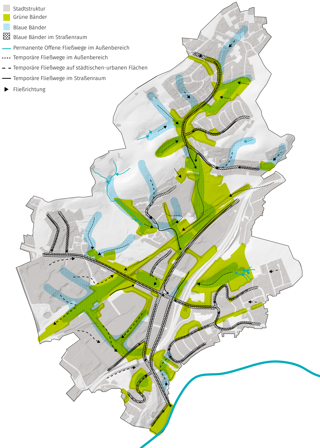
Abb. 104 Die verschiedenen Fließwegetypen werden zu „blauen Bändern“ weiterentwickelt und vernetzen die Stadträume. Bereits vorhandene Grün- und Brachflächen werden mit den Rückbaugebieten zu grünen Bändern untereinander verknüpft und schaffen ein neues Wege- und Grünnetz, dass die Quartiere und Stadträume miteinander verbindet. Gemeinsam ergeben sie ein „blau-grünes Netz“ mit Modellgebiet (ILPÖ 2015)
