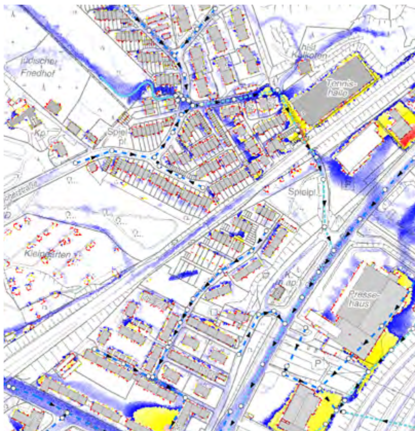
Abb. 119 Überflutungssimulation für das Fokusgebiet II im IST-Zustand für T=30a mit Abflussbildung über das Kanalnetzmodell (oben) und Abflussbildung über das Kanalnetz- und Oberflächenmodell (unten) (Dr. Pecher AG 2016)
