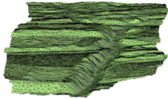
Abb. 24 Die Oberfläche wird in GeoCPM über Dreieckselemente nachgebildet (Dr. Pecher AG 2015)
