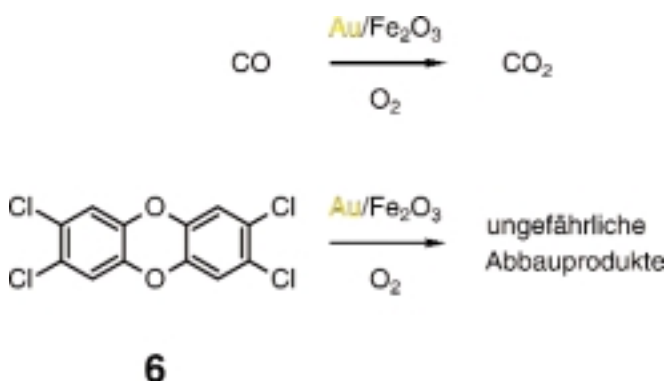
Abb. 9: Schon bei niedrigen Temperaturen werden Kohlenmonoxid (CO) und Dioxin 6 an Gold-Katalysatoren oxidiert.
