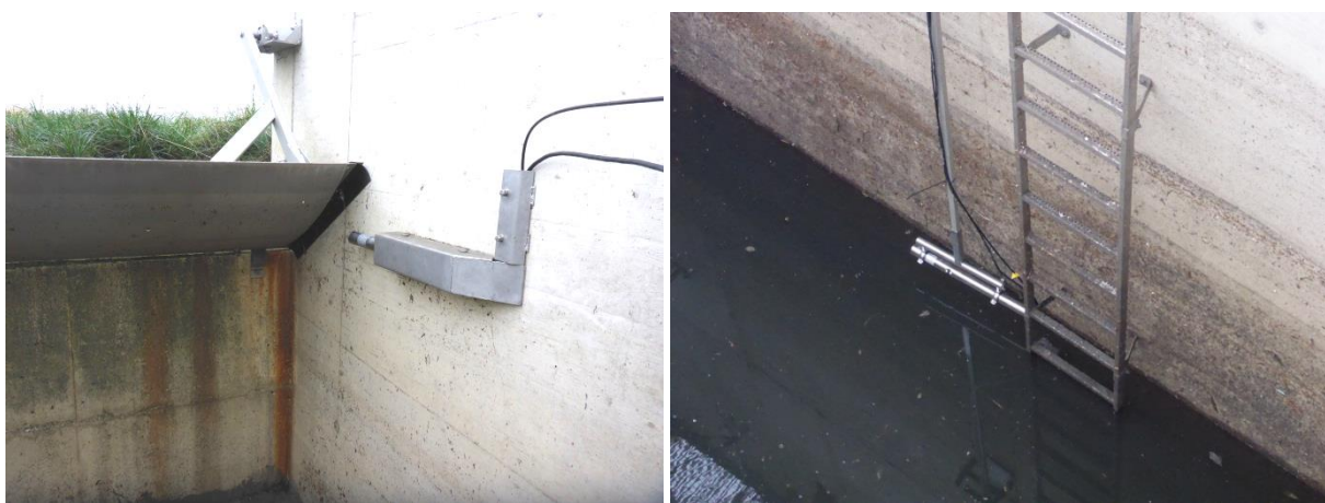
Abbildung 7: Installation an der Schwelle, links: feste Installation, rechts: klappbare Installation
