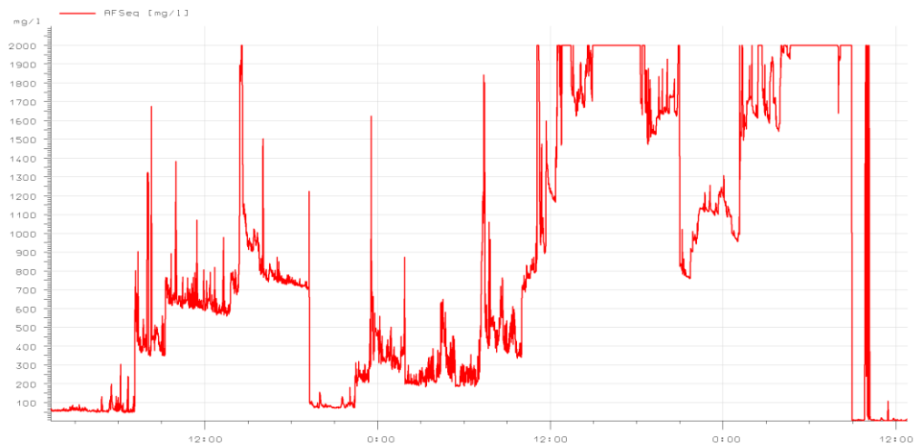
Abbildung 12: Sprunghafte Plateau-Bildung der Messwerte durch Verschmutzung des Messfensters einer Spektromettermessung
