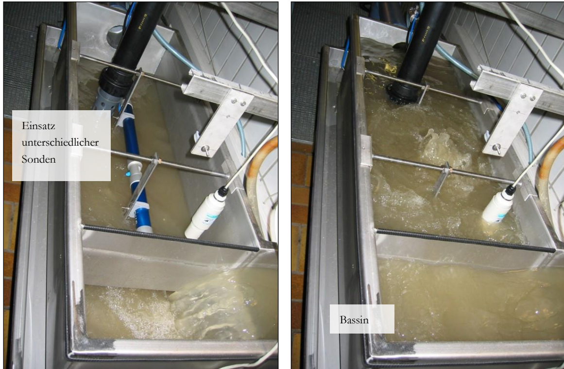
Abbildung 4: Bypass-Installation, von oben befülltes Bassin (Quelle: TU Graz)
