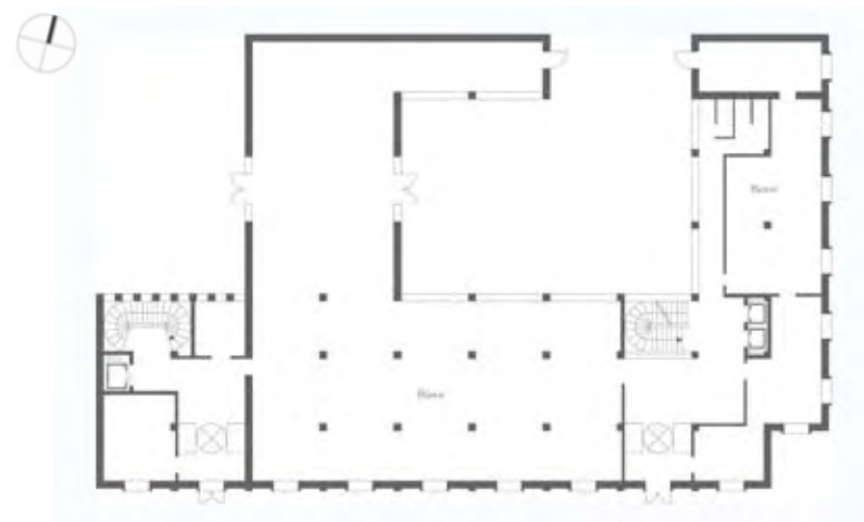
WV 217. Bürogebäude Bd. Carol I., Erdgeschoss-Grundriss, M 1:500.
