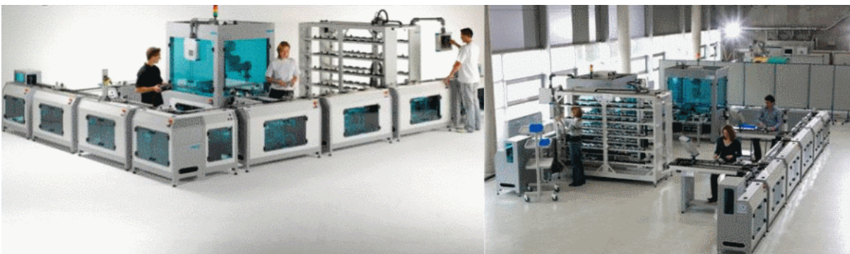
Abbildung 4.1: Realer Aufbau des iTRAME-Systems am Institut für Industrielle Fertigung und Fabrikbetrieb (IFF) der Universität Stuttgart [Ins17]. Die gleichen Baugruppen können für unterschiedliche Anordnungen verwendet werden.
