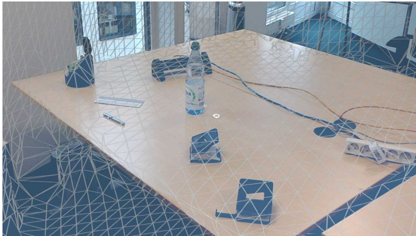
Abbildung 3.16: Darstellung des Umgebungsmodells eines Tisches mit mehreren Gegenständen. Zu sehen ist, dass nur größere Elemente einen Einfluss auf das Umgebungsmodell haben.
