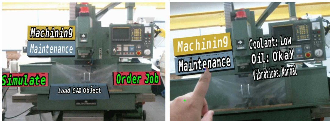
Abbildung 2.15: Einblendung von Informationen an einer Werkzeugmaschine. Links: Angezeigte Daten während des Normalbetriebs, rechts: Angezeigte Daten während der Wartung [YON16].
