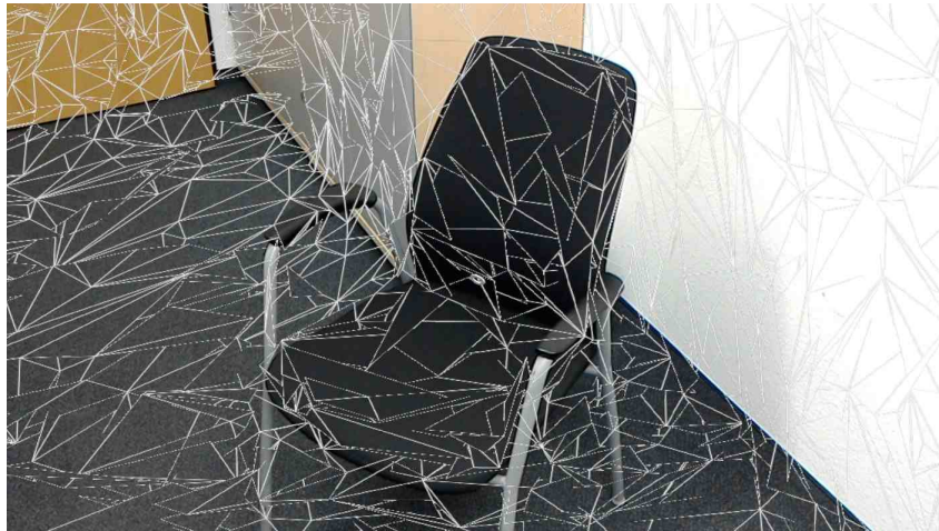
Abbildung 3.14: Darstellung des von der HoloLens aufgenommenen Umgebungsmodells eines Stuhls als Drahtgitter.
