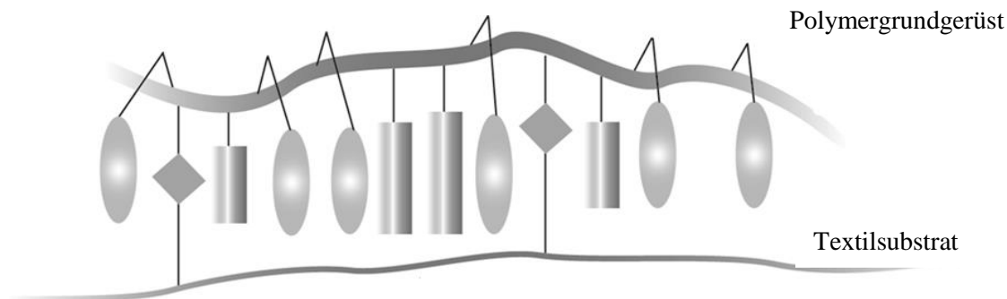
Abbildung 7: Orientierung von Seitenketten-fluorierten Polymeren nach langsamem Abkühlen in polarem Medium.
