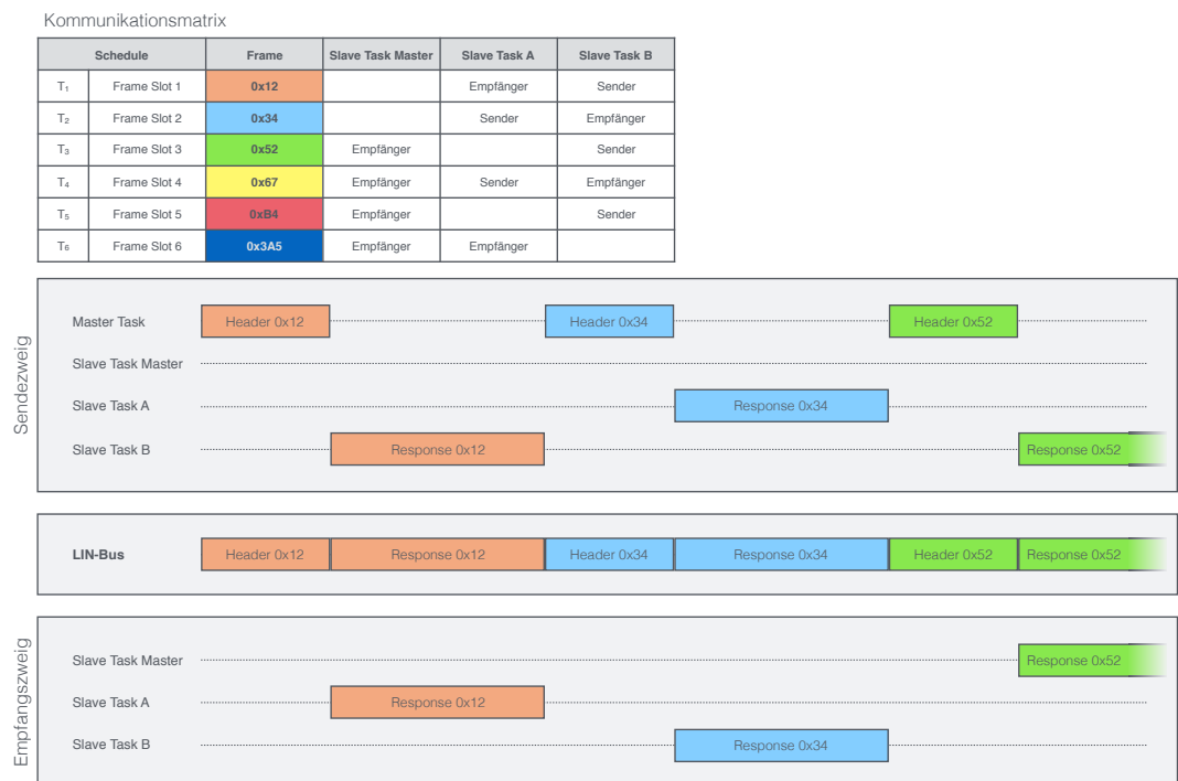
Abbildung 2.8. Beispielhafte Kommunikation in einem LIN-Netzwerk mit drei Knoten (angelehnt an [5])
