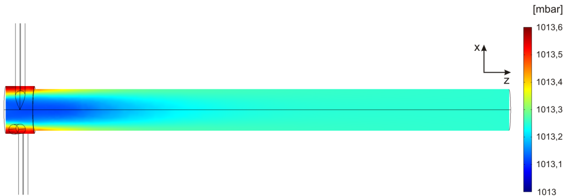
Abbildung 5.17: Die tangentielle Hüllströmung verursacht durch ihre hohen Strömungsgeschwindigkeiten hohe Drücke an der Rohrwand nahe den Gaseinlässen. Dadurch kommt es zum Zentrum des Rohres hin zu einem Druckabfall.
