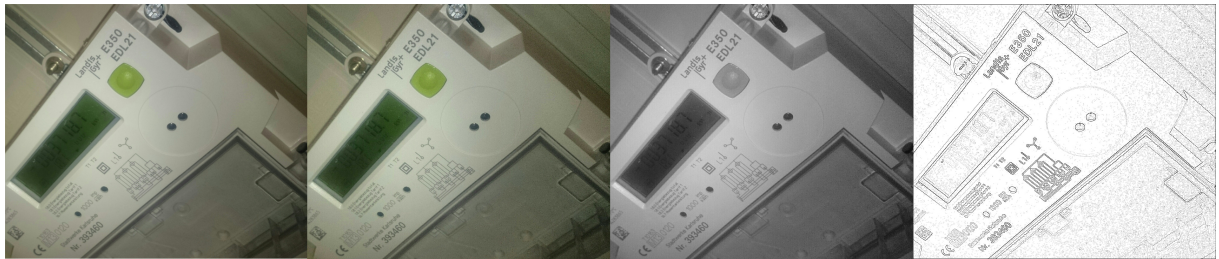
Abbildung 6.1: Visualisierung des Vorgehens zur Kantenerkennung. V.l.n.r: ursprüngliches Bild (2,3MB), skaliertes Bild auf 800x600px (0,64MB), skaliertes Bild in Graustufen (0,59MB), invertiertes und verstärktes Ergebnis der Kantenerkennung (0,55MB)
