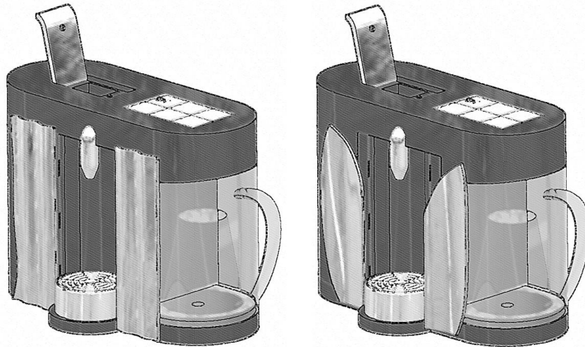
Bild 6: Individualisierbare Teemaschine mit verschiedenen Blenden
