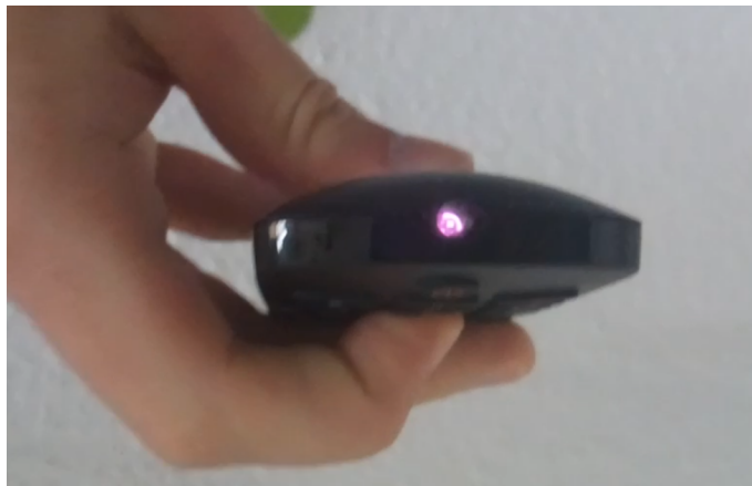
Abbildung 4.19: Auch Smartphonekameras erkennen Infrarotlicht.
