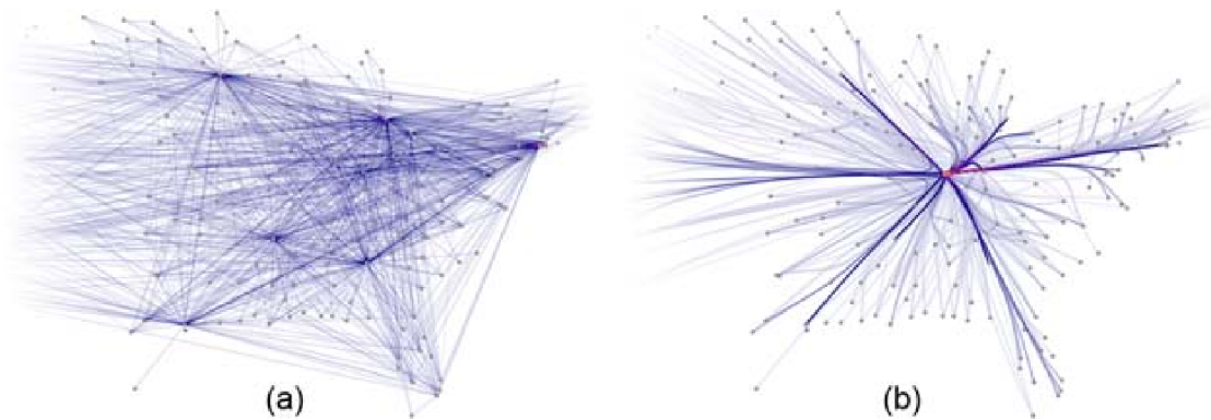
Abbildung 3.7: a) zeigt ein Knoten-Kanten Diagramm, in b) wurden die Kanten mit Edge Bundling zusammengefasst. Es ist deutlich weniger visuelle Unordnung vorhanden. Entnommen aus [HW09] Seite 4
