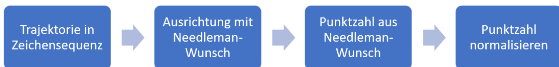
Abbildung 3.4: Ablauf von ScanMatch. Needleman-Wunsch wird in Abbildung 3.3 gezeigt.
