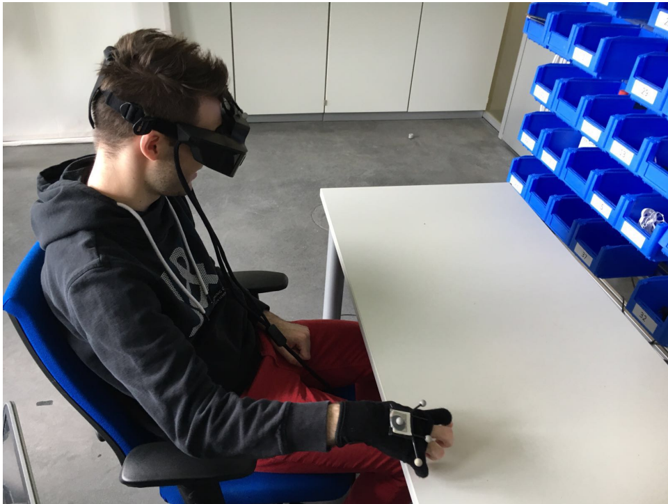
Abbildung 6.2: Einer der Probanden, der mithilfe des Handschuhs einen virtuellen Würfel greift, um die Farbe eines anderen zu verändern.
