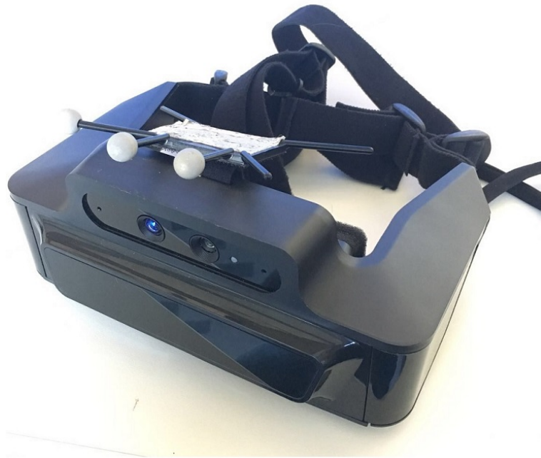
Abbildung 5.1: Meta 1 Augmented Reality Brille mit einem rigid Body, an dem sich drei Marker befinden. Diese werden benötigt, damit die Brille von dem OptiTrack System erfasst werden kann.
