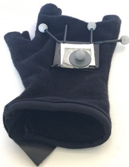
Abbildung 6.3: Der Handschuh, der von dem Probanden getragen werden musste damit er mit dem virtuellen Würfel interagieren konnte.
