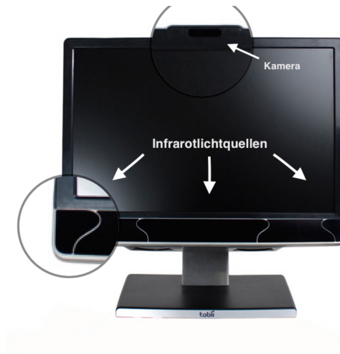
Abbildung 2.4: [www.tobii.com]Remoter Eyetracker Tobii T60XL des Herstellers Tobii.
