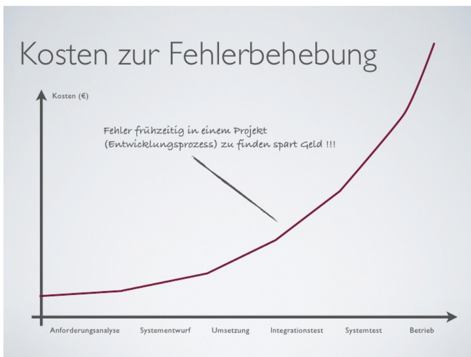
Abbildung 3.1: [ http://de.slideshare.net/ ]. Die Graphik betont das exponentielle Wachstum der Kosten um einen Fehler zu beheben in jeder Entwicklungsphase von Software.
