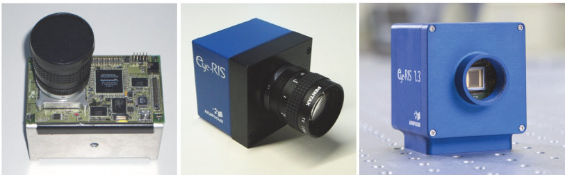
Bild 5.4: Verschiedene CNN-Kameras von ANAFOCUS, die im Projekt ACES verwendet wurden. V.l.n.r.: EyeRIS 1.1, EyeRIS 1.2 und EyeRIS 1.3 [108].
